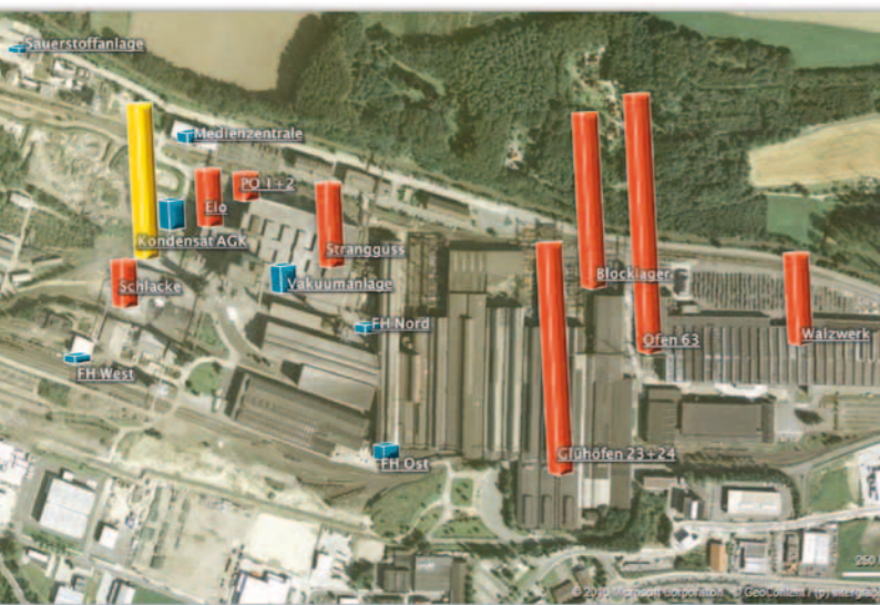
Die Werksübersicht mit den Potenzialbalken verdeutlicht: Hier wurden Wärmequellen und Wärmesenken identifiziert.
