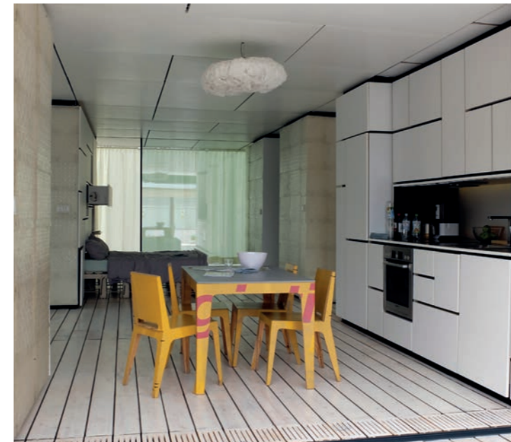
Ein Modellhaus der RWTH Aachen: Fassade aus CDs, Fußboden aus alten Holzträgern und Schränke aus Sperrmüllmöbeln
