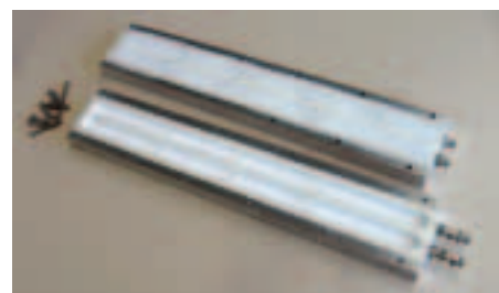
Biogas lässt sich mithilfe von ionischen Flüssigkeiten in Plattenmodulen reinigen.
