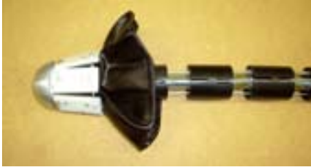
Multifunktionskopf des Teleskoparms, der als Träger für Lichtquelle sowie als Adapter für verschiedene Sanierungswerkzeuge und eine Vor- und Rückkamera dienen kann.
