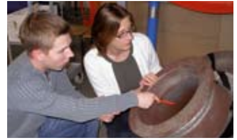
Ein neuer Verschleißschutz für Eisenmetalle auf Emailbasis ist energiesparend, emissionsarm und ressourcenschonend in der Verarbeitung.
