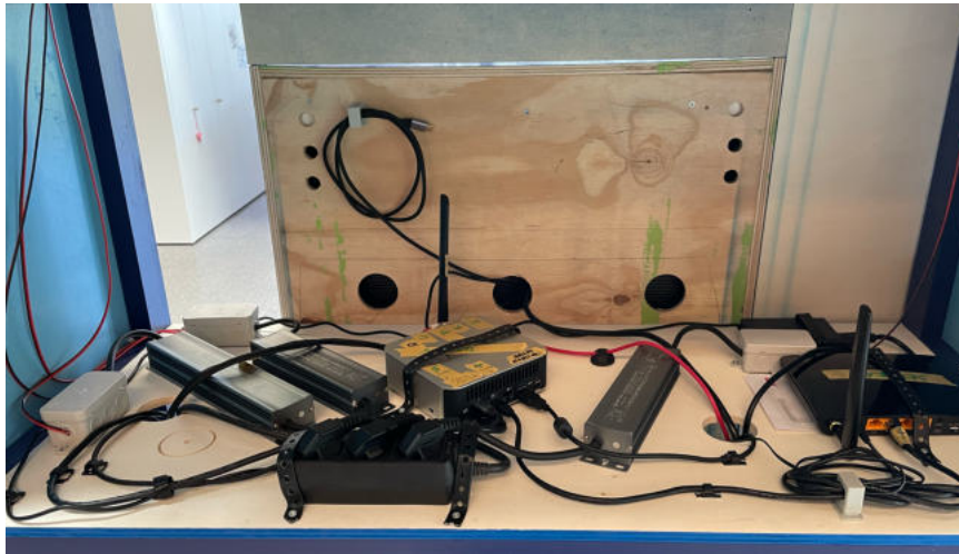
von rechts: Router mit Netzwerk, Mini-PC, er steuert den großen Screen auf der Frontseite und den kleinen Screen auf der Rückseite, Mehrfachsteckdose, Beleuchtung
