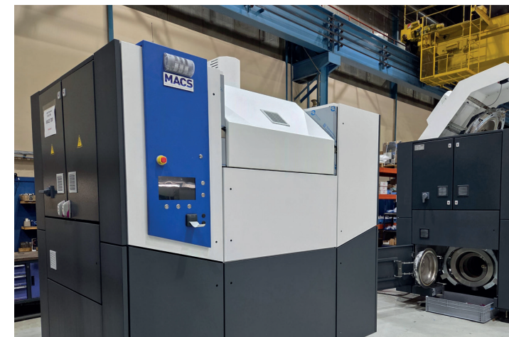
Durch das MACS (Machine Autoclave Cutting Sterilization)-System der ERMAFA GmbH werden pathogene Mikroorganismen vollständig inaktiviert.
