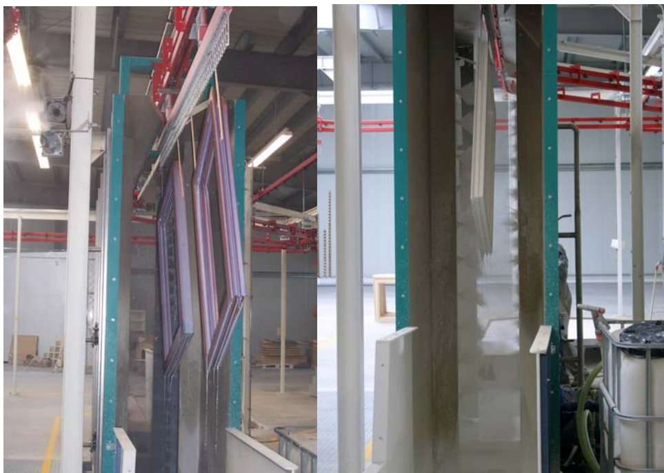
Bild 4: Prototyp der neuen Flutanlage im Technikum der Firma Rhenocoll bei ersten konventionellen Flutversuchen im März 2004
