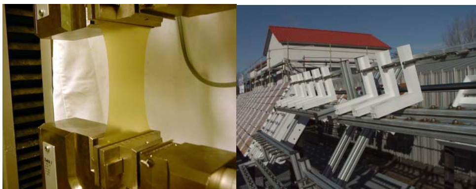
Bild 2: Prüfung der Elastizität eines flutfähigen Deckbeschichtungslabormusters (nussbaum) und Freilandbewitterung von ganzheitlich deckend-weiß gefluteten Holzfenstereckkanteln (L-joints) der zweiten Labormustergeneration ( Stand Februar 2004 )
