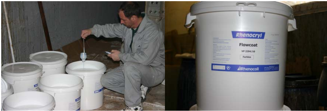
Bild 1: Viskositätsprüfung von Flowcoat Gebinden für den ersten großtechnischen Einsatz im Frühjahr 2004 im Anwenderzentrum in Konken; rechts: erstes 5l Gebinde einer farblosen Laborcharge
