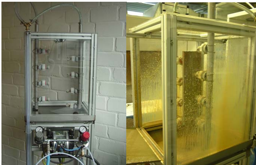
Bild 3: Patentierte Miniaturflutanlage (Patent PST-Fall Nr.: 03F43731-WKI) nach dem Bau und während der Applikation eines lasierenden Flutlackes (nussbaum) auf ein Kiefernholznormbrett
