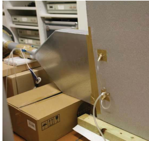
Abb. 41: Anschlussstück mit Druckaufnahme in den Kanälen
