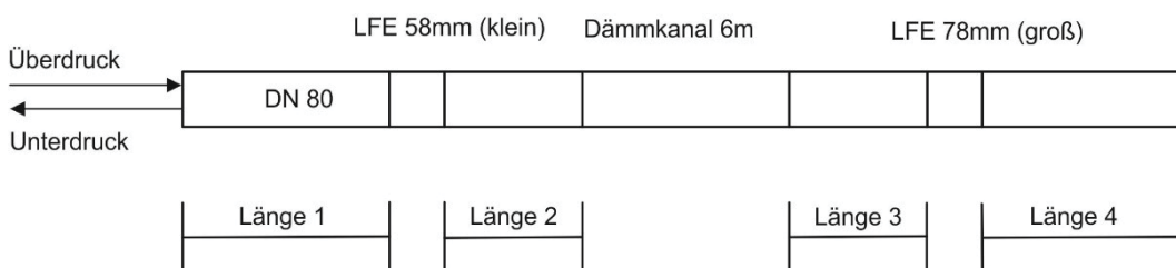
Abb. 58: Schematische Darstellung des Aufbaus der Volumenstrommessung mit unterschiedlich langen Ein- und Auslaufstrecken
