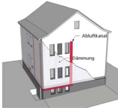
Abb. 2: Kanalführung an einem Wohngebäude 2
