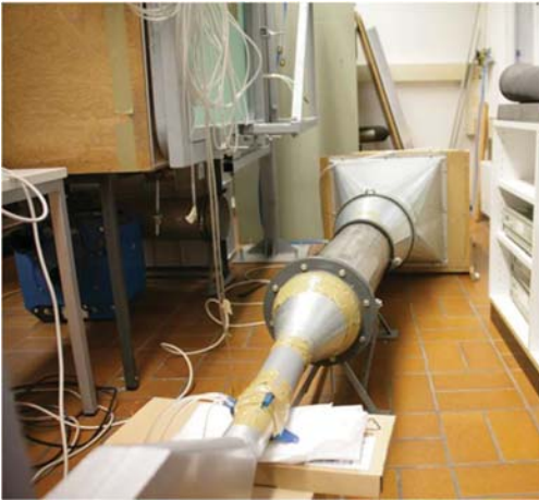
Abb. 40: Messaufbau mit Ventilator, Beruhigungsstrecke und LFE
