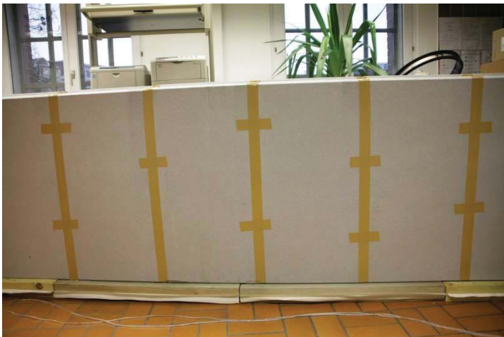
Abb. A 11: Abgeklebte 6 m lange Messkanalstrecke
