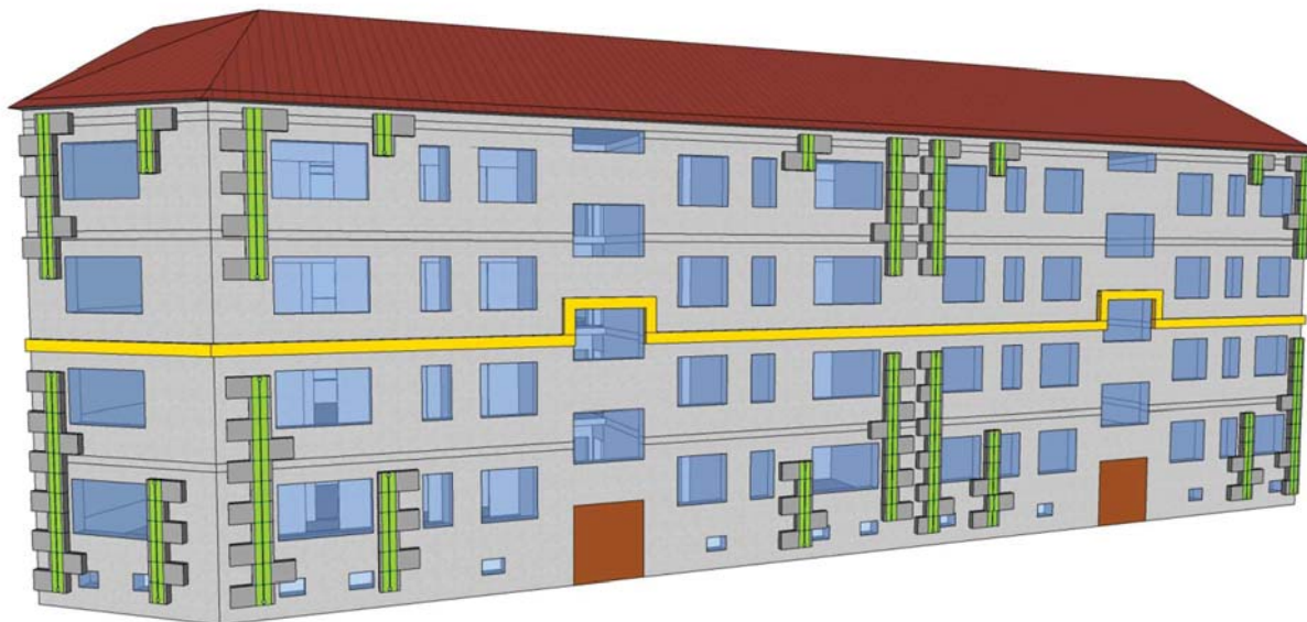
Abb. 97: Westansicht der Gebäude mit fassadenintegrierter Zuluftkanalführung für das zentrale Lüftungssystem
