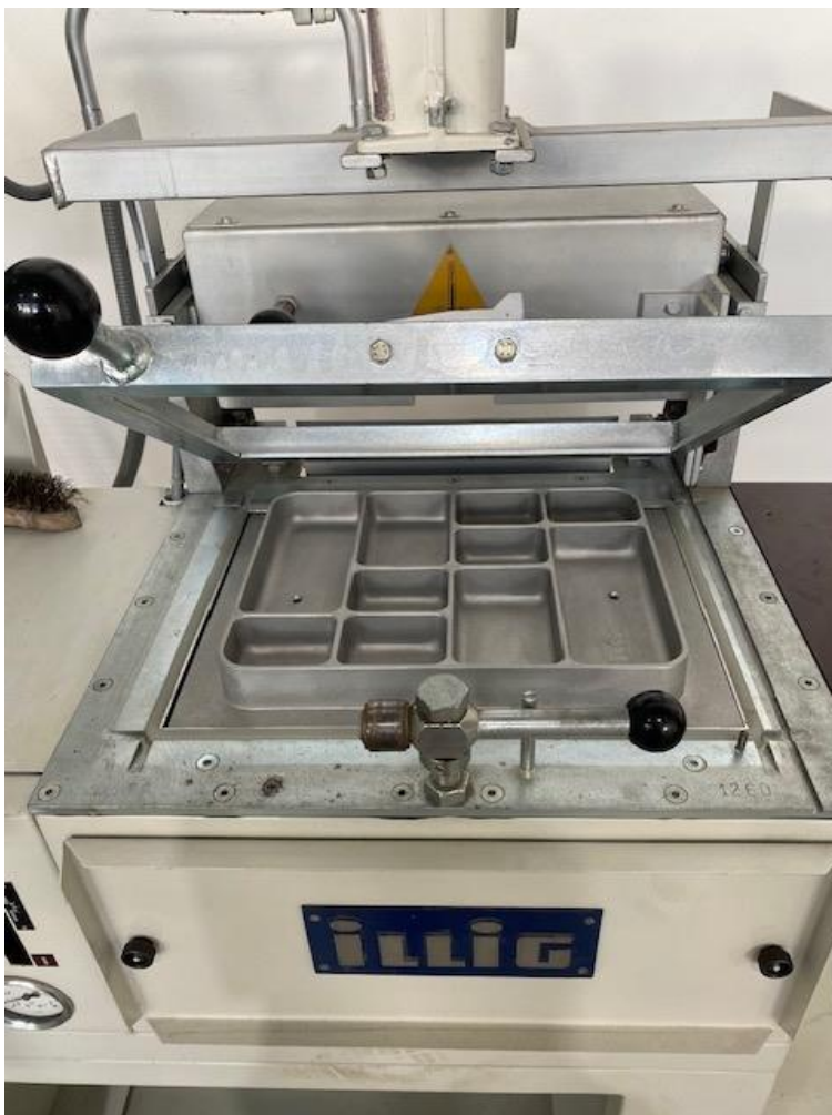
Abb. 4: Tiefziehgerät KFG37 und verwendete Tiefziehform ‚Besteckkasten‘
