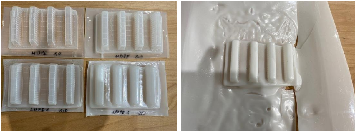
Abb. 10: Beispiele für tiefgezogene Drainagen; links: HDPE + LDPE1 1,0 und 2,0 mm; rechts: PBS 2,0 mm
