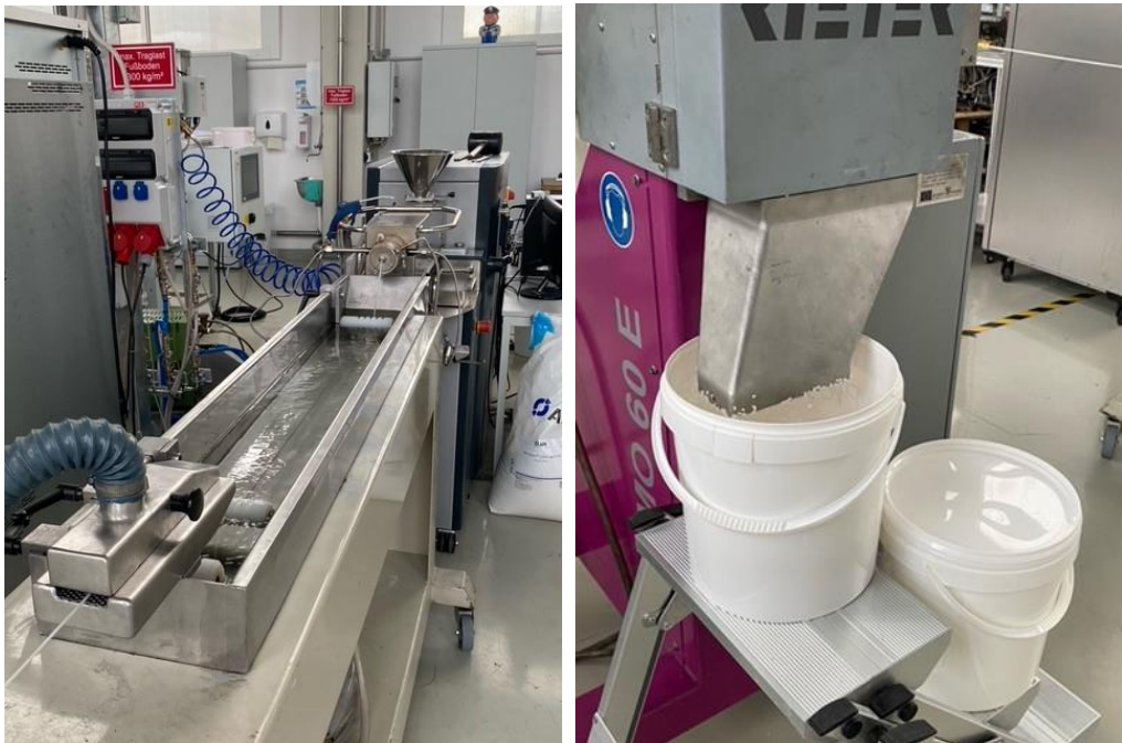
Abb. 12: Einschneckenextruder mit Strangdüse, Wasserbad (links) und Granulator (rechts)
