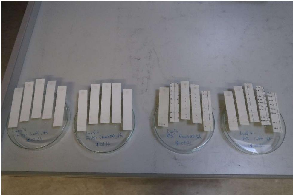
Abb. 7 Beimpfte Papier-Teststreifen von Lauf 4, die entweder mit Ozon behandelt wurden, oder dieselbe Zeit unter der Sterilwerkbank lagerten.
