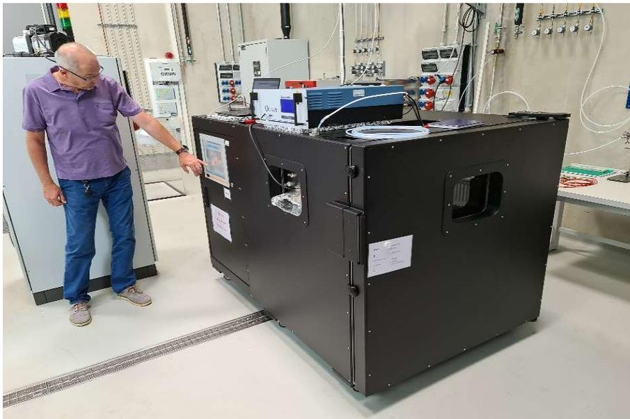
Abb. 2 Klimakammer für Ozonversuche am Fraunhofer-Institut für Bauphysik. Quelle iconyk GmbH 2022.
