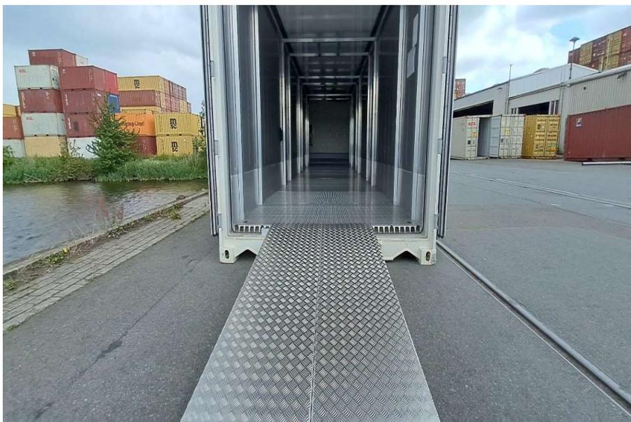
Abb. 15 Einbau des Aluminiumgestell, Lochblechboden und Rampe. Quelle: Sven Hoppe 2023.
