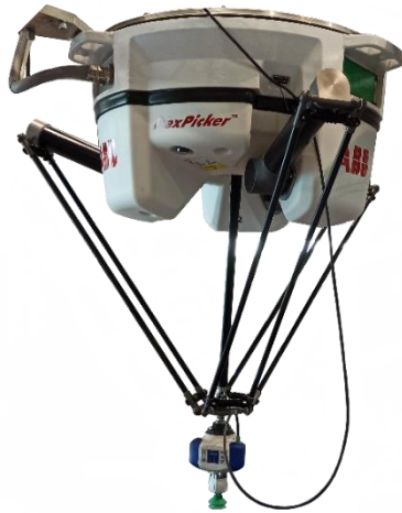
Abbildung 10: Beispiel für einen Delta-Roboter. © Marc Auledas, CC BY-SA 4.0 , via Wikimedia Commons
