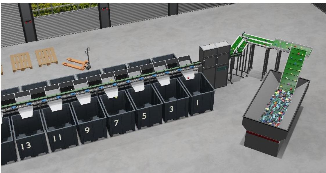
Abbildung 24: 3D-Entwurf einer SORT4CIRCLE®-Sortieranlage für Verschlusskappen, bestehend aus Hochförderung aus dem Bunker, Vereinzelungsstrecke mit Teilparallelisierung, zwei Detektionskammern und Sortierband mit Druckluftdüsen zum Abblasen der Teile in Sammelboxen
