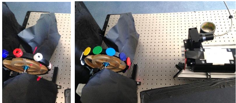
Abbildung 21: Messaufbau mit Drehscheibe. Linkes Bild: Verschlusskappen. Rechtes Bild: Farbplättchen, rechts oben: Laseroptik mit Lichtleitfaser. Rechts, Mitte: Objektiv des Detektormoduls
