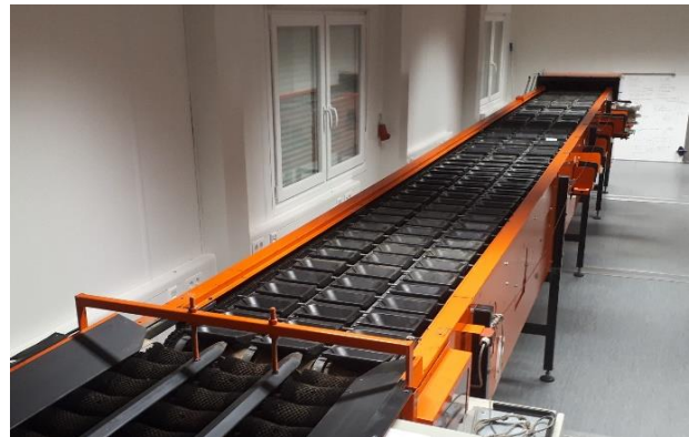
Abbildung 11: Apfelsorter vor Rückbau der Rundbürsten am Bandanfang und Aufbau der neuen Detektionshaube
