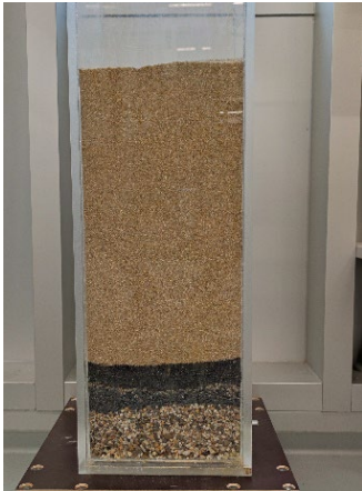
Abbildung 5: Sandfilter nach Empfehlung der CAWST - System (links) und Baumaterial vor dem Aufbau in Uganda
