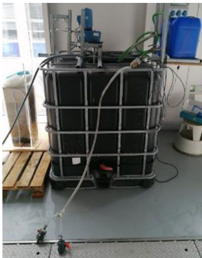
Abbildung 6: Versuchsstand zur Herstellung und Zugabe des Testwassers
