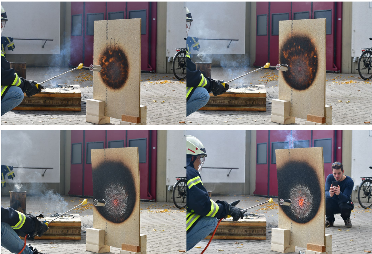
ABB. B 157: Brandversuch ESB: 0:30min Verkohlung / 1:10min Asche / 6:10min Glut im Zentrum / 11:10 Durchbruch
