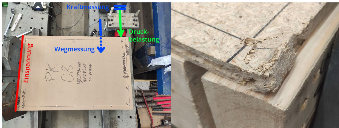
ABB. B 21: Versuchsaufbau Bauteilversuch (links) Versagen der Beplankungs-Befestigung(rechts)
