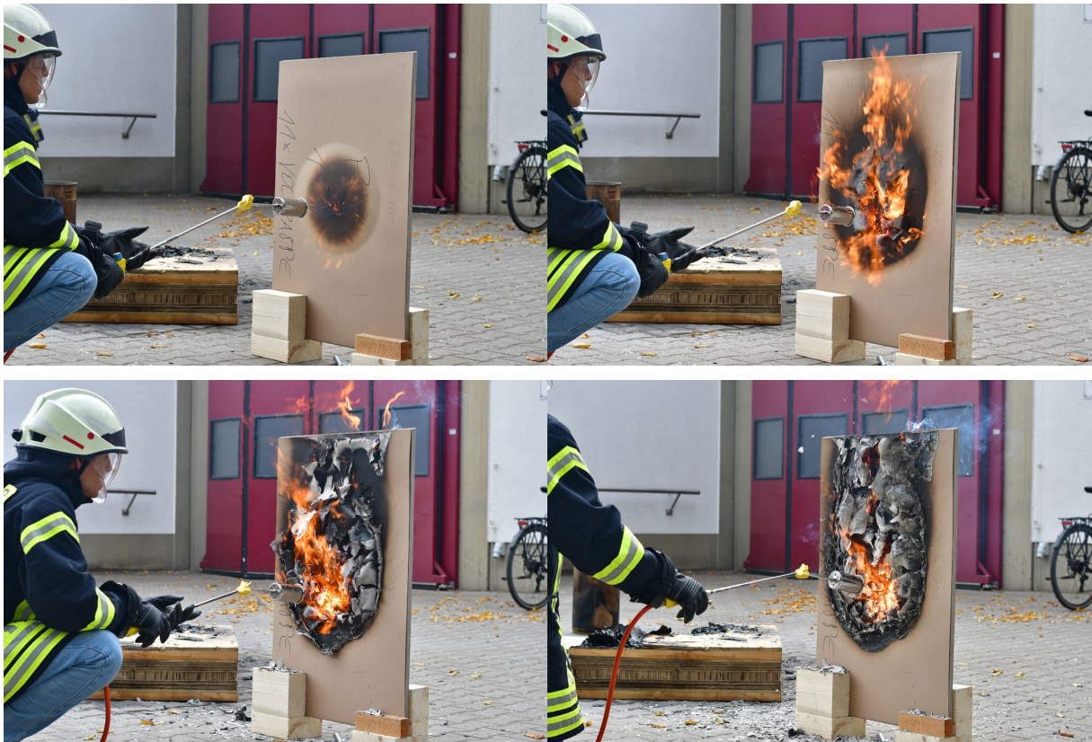
ABB. B 168: Brandversuch Karton: 0:10min Verkohlung / 0:40min Flammen / 3:10min Ausbreitung bis zum oberen Rand / 10:20 Durchbruch
