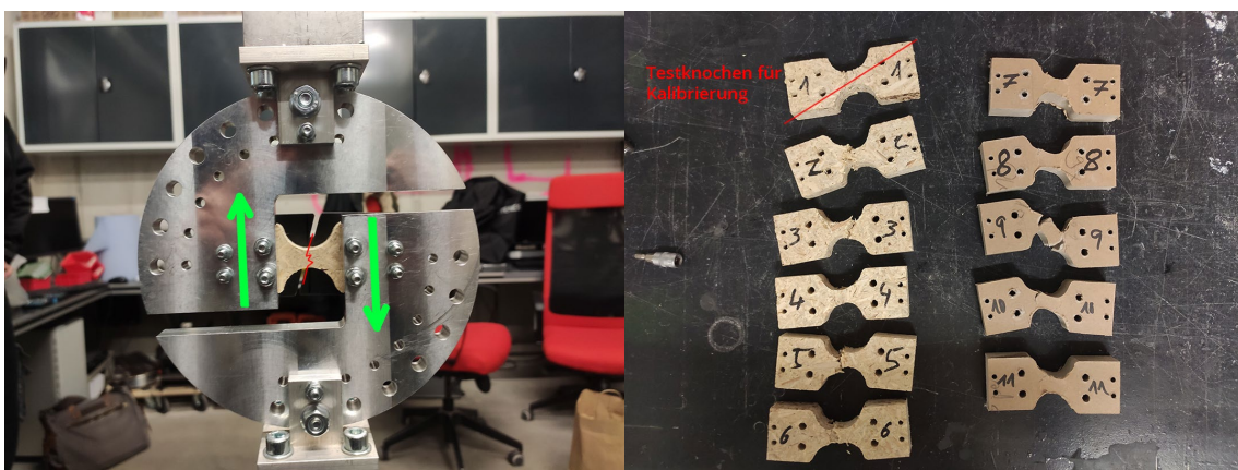
ABB. B 23: Schubversuch, Aufbau (links) und Probekörper nach dem Versuch (rechts)
