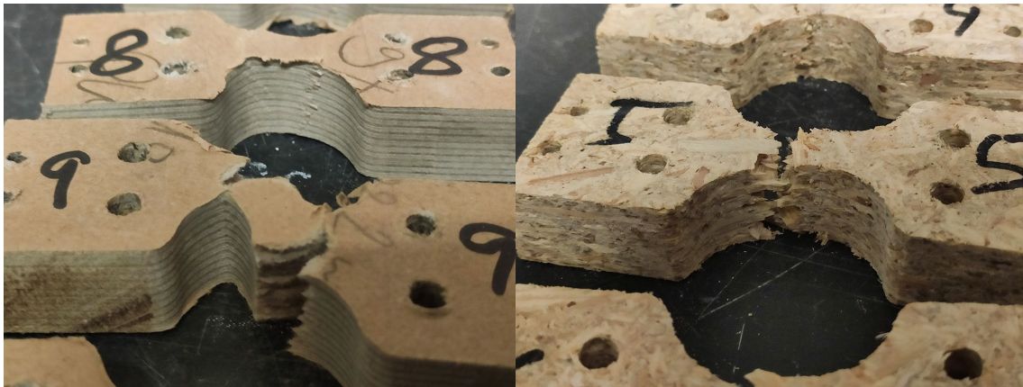
ABB. B 25: Schadensbild an Karton (links) und ESB (rechts)
