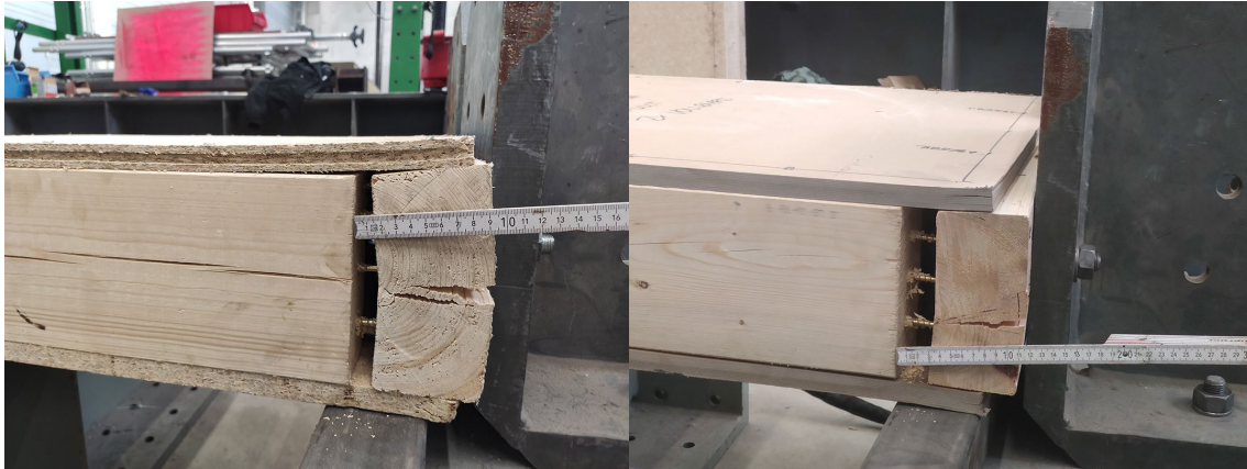
ABB. B 22: Rahmenversagen bei ESB-Beplankung (links) und Karton-Beplankung(rechts)
