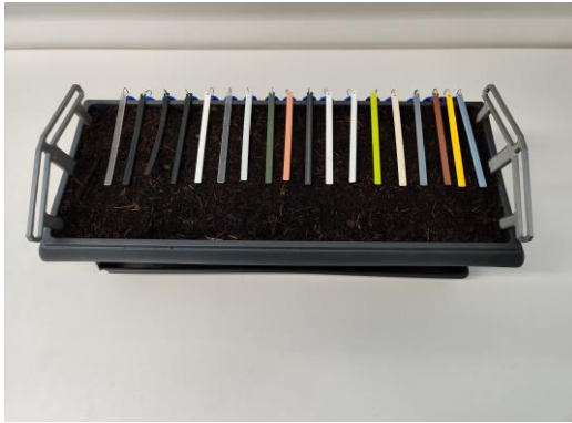
Abbildung 13: Gefäß für den Kompostierversuch und Kompostierstäbchen [eigene Darstellung]
