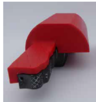
Bild 1 • Nicht zu beschichtende Bereiche werden mittels additiv gefertigter Maskierung abgedeckt.
