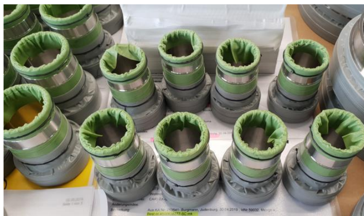
Abbildung 1: Mit Klebeband maskierte Bauteile zur Beschichtung
