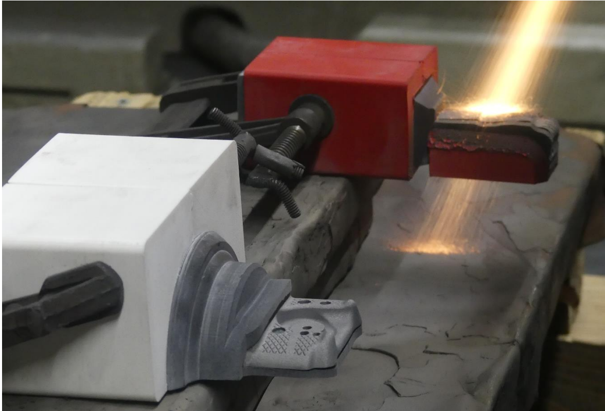
Abbildung 31: Einspannung im Versuch zur mechanischen Belastbarkeit [eigene Darstellung]
