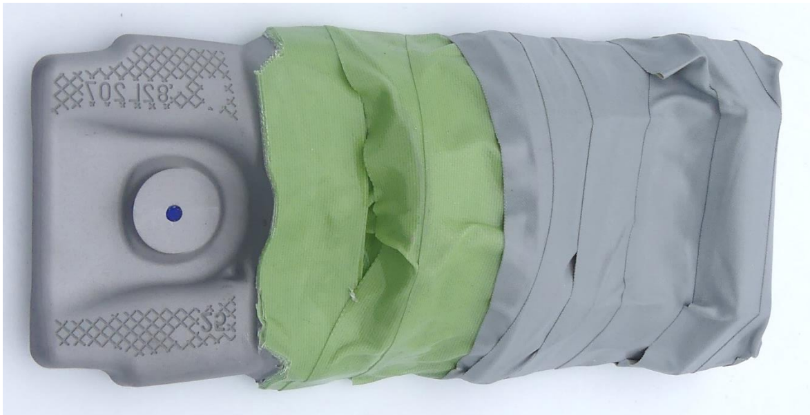
Abbildung 367: Maskierter side core big mit Klebeband [eigene Darstellung]
