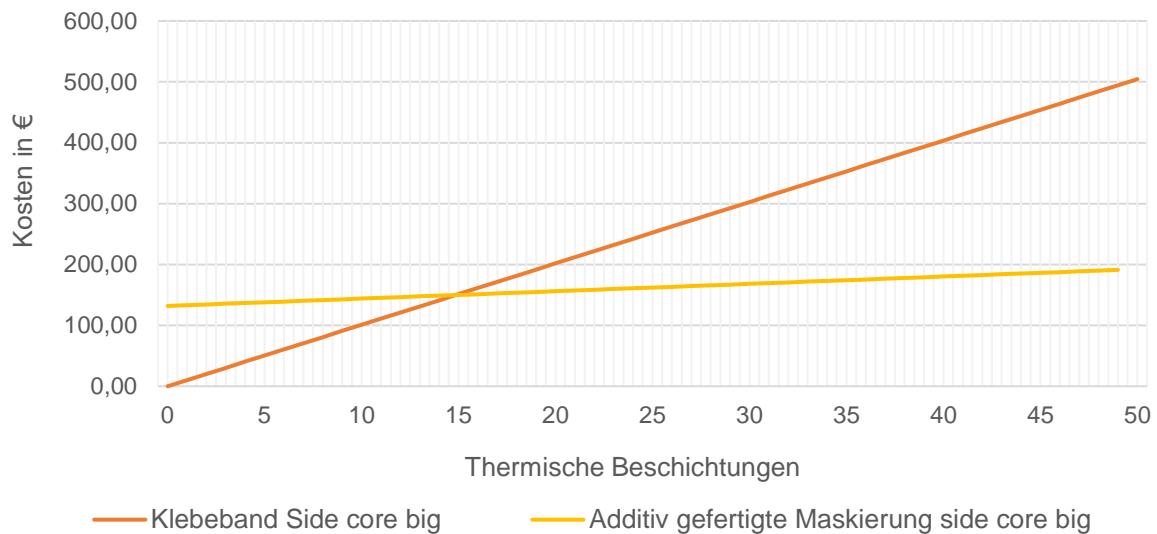
Abbildung 41: Diagramm Break-even-Point beim side core big [eigene Darstellung]
