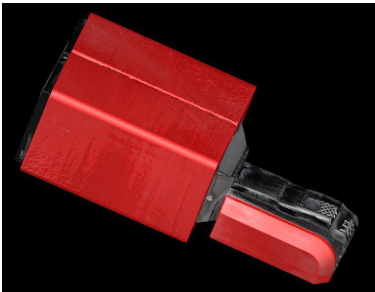
Abbildung 38: Finale Maskierung als Materialverbund aus weichem Material innen und Hartschale außen
