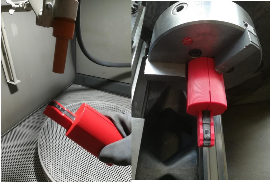
Abbildung 7: Maskierung als Handlingtool in Stahlkabine und auf der Spritzbank
