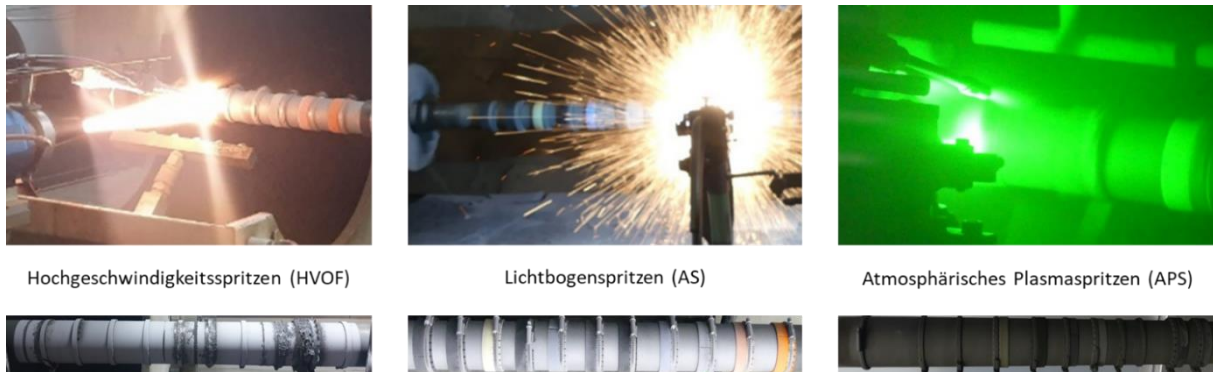
Abbildung 12: Beschichtung der Rohrmaskierungen mit verschiedenen Beschichtungsverfahren
