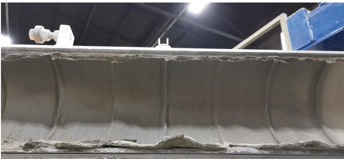
Abbildung 45: Zementschale an der Wand des Mixers
