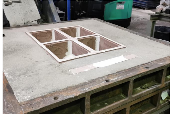
Abbildung 46: links) Vollform-Modell B-Säulen Probekörper mit Anschnitt im Unterkasten, rechts) gewendeter Unterkasten
