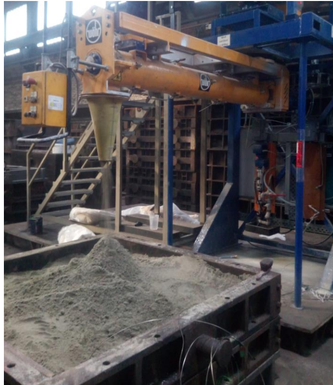
Abbildung 43: Durchlaufwirbelmischer bei der Herstellung des Unterkastens - Formrezeptur: Formgrundstoff – Quarzsand QQS 60, 8 % Ettringitzement mit w/z-Wert = 0,5 entspricht 4 % Wasser sowie Additive
