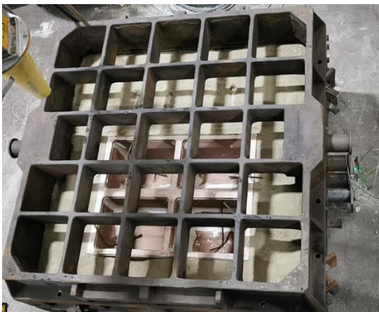
Abbildung 47: links) Aufgesetzter Oberkasten, rechts) Formen des Oberkastens
