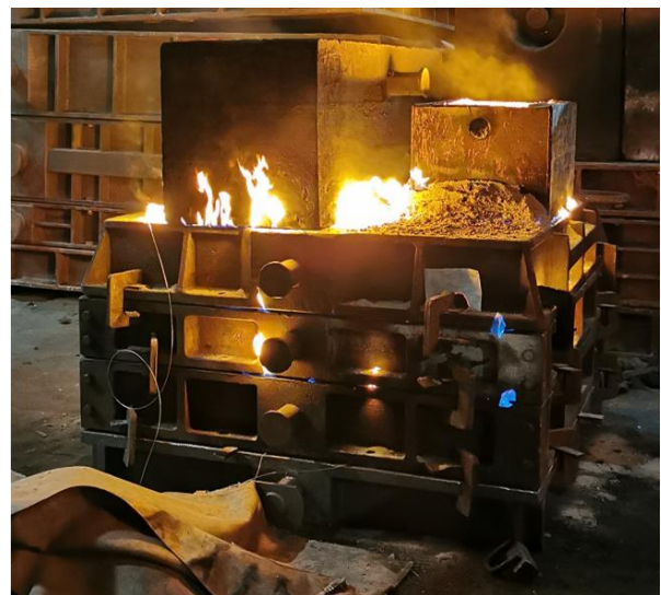
Abbildung 48: links) Abgussbereite Form, rechts) Form nach Abguss
