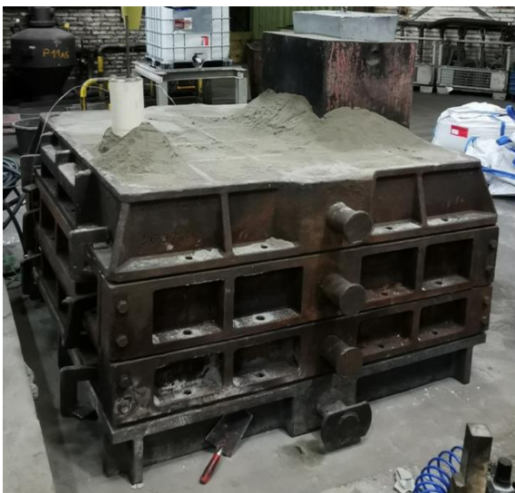
Abbildung 48: links) Abgussbereite Form, rechts) Form nach Abguss
