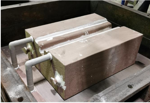
Abbildung 46: links) Vollform-Modell B-Säulen Probekörper mit Anschnitt im Unterkasten, rechts) gewendeter Unterkasten
