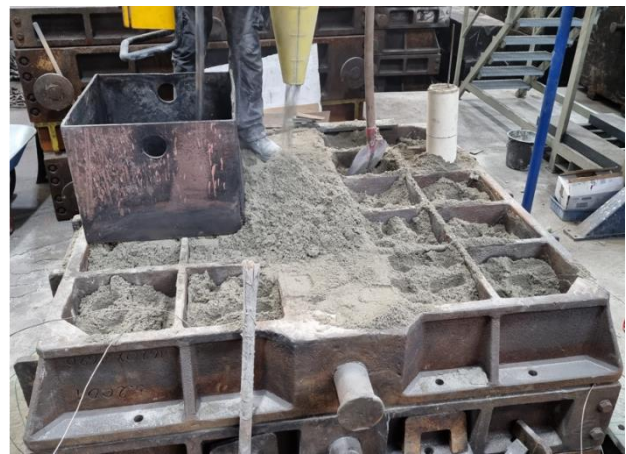
Abbildung 47: links) Aufgesetzter Oberkasten, rechts) Formen des Oberkastens
