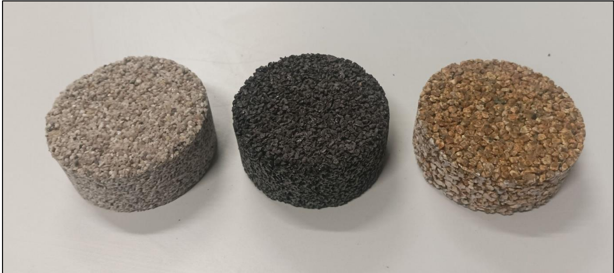
Abb. 3.4: Probekörper der kunstharzgebundenen Baustoffgemische KB1, KB2 und KB3 [Bromberg, 2021]
