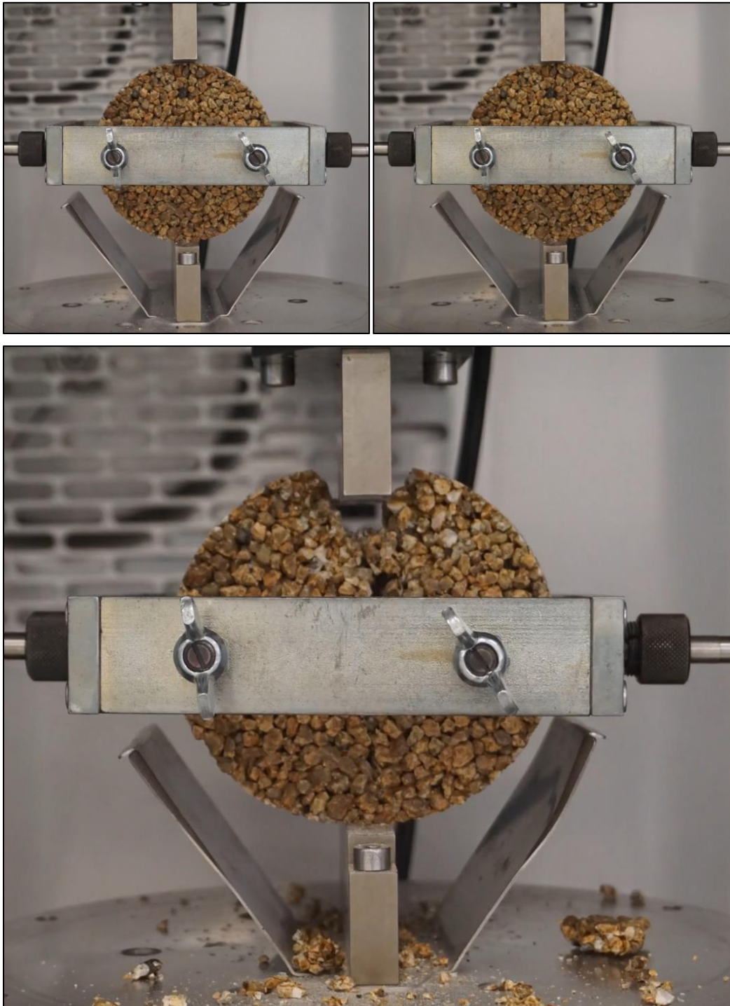
Abb. 5.14: Ermüdungsverhalten des Baustoffgemisches KB3 [Bromberg, 2022]
