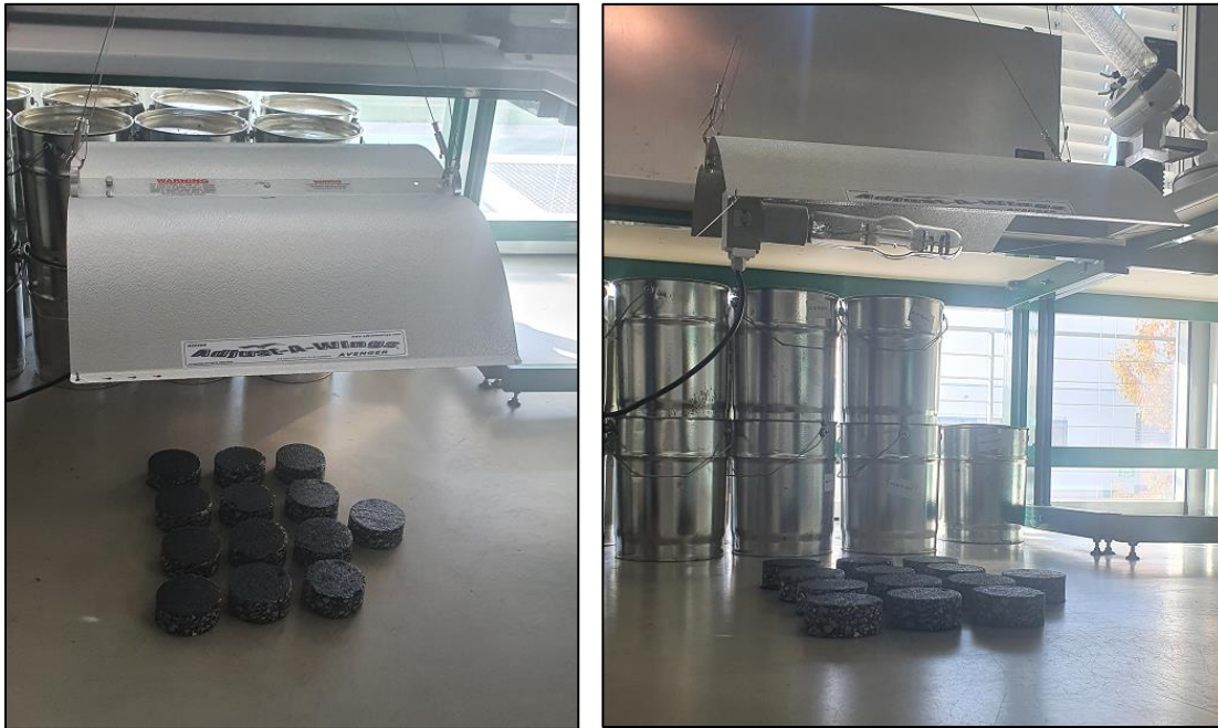
Abb. 4.8: Probekörper unter Metallhalogendampflampe [Bromberg, 2021]
