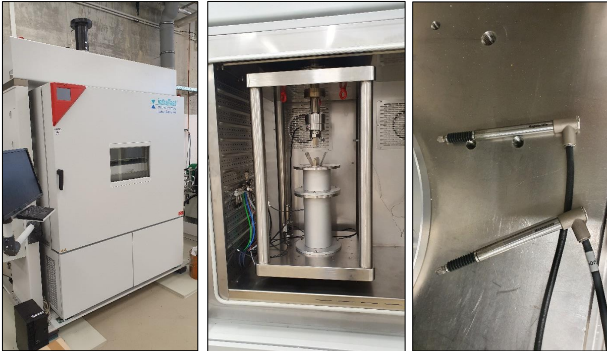
Abb. 4.4: Servohydraulische Präzisionsprüfmaschine (links), Innenkammer der Prüfmaschine (Mitte), Wegaufnehmer (rechts) [Bromberg, 2021]
