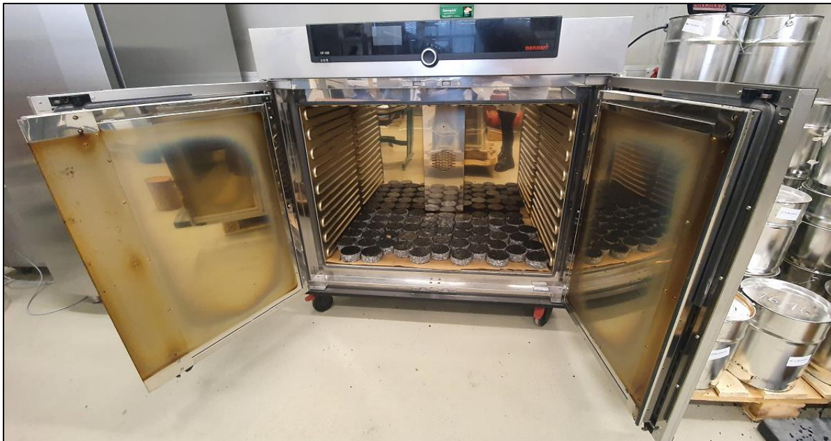
Abb. 4.7: Wärmeschrank mit Probekörpern [Bromberg, 2021]
