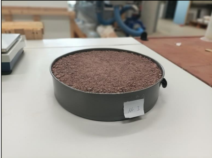
Abb. 4.13: Probekörper in Metallform für Versuche mit Wasserzugabe [Bromberg, 2022]
