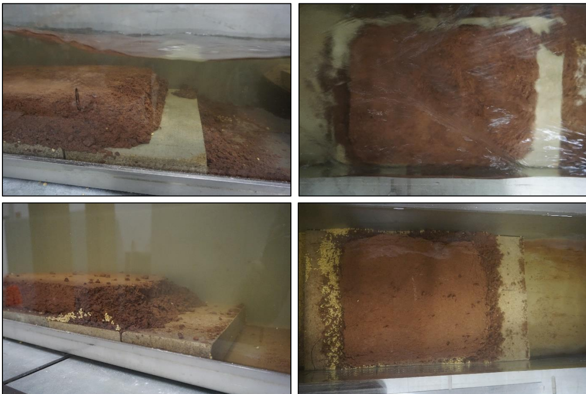
Abb. 5.54: Extremversuche mit starkem Strömungsangriff, UB1 oben, UB2 unten [Bromberg, 2022]
