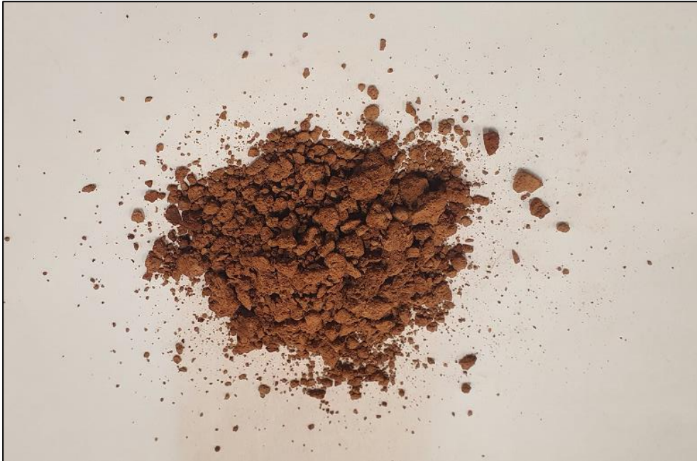
Abb. 2.8: Gesteinskörnung des ungebundenen Baustoffgemisch UB2 [Bromberg, 2021]
