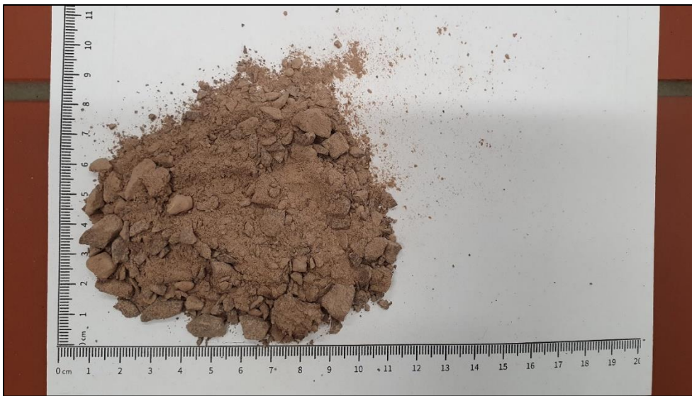
Abb. 2.7: Gesteinskörnung des ungebundenen Baustoffgemisch UB1 [Bromberg, 2021]
