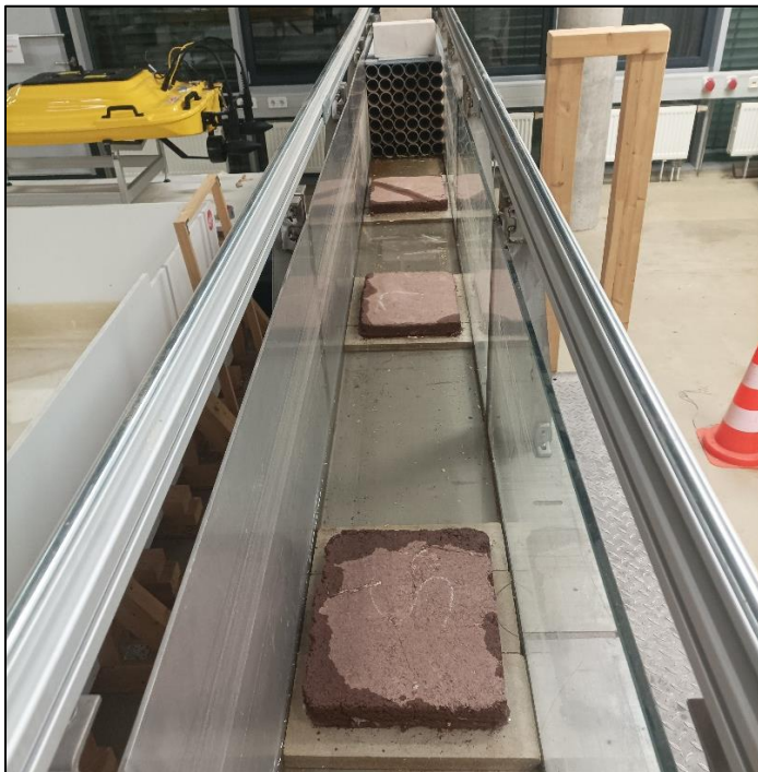
Abb. 4.19: Anordnung der Probekörper der Baustoffgemische UB1 und UB2 im Versuchsaufbau [Bromberg, 2022]
