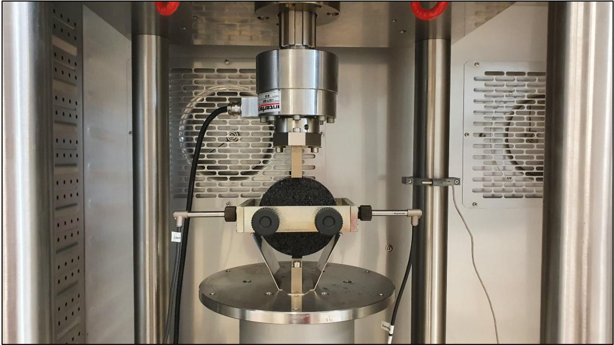
Abb. 4.6: Servohydraulische Präzisionsprüfmaschine mit eingebautem Probekörper [Bromberg, 2021]
