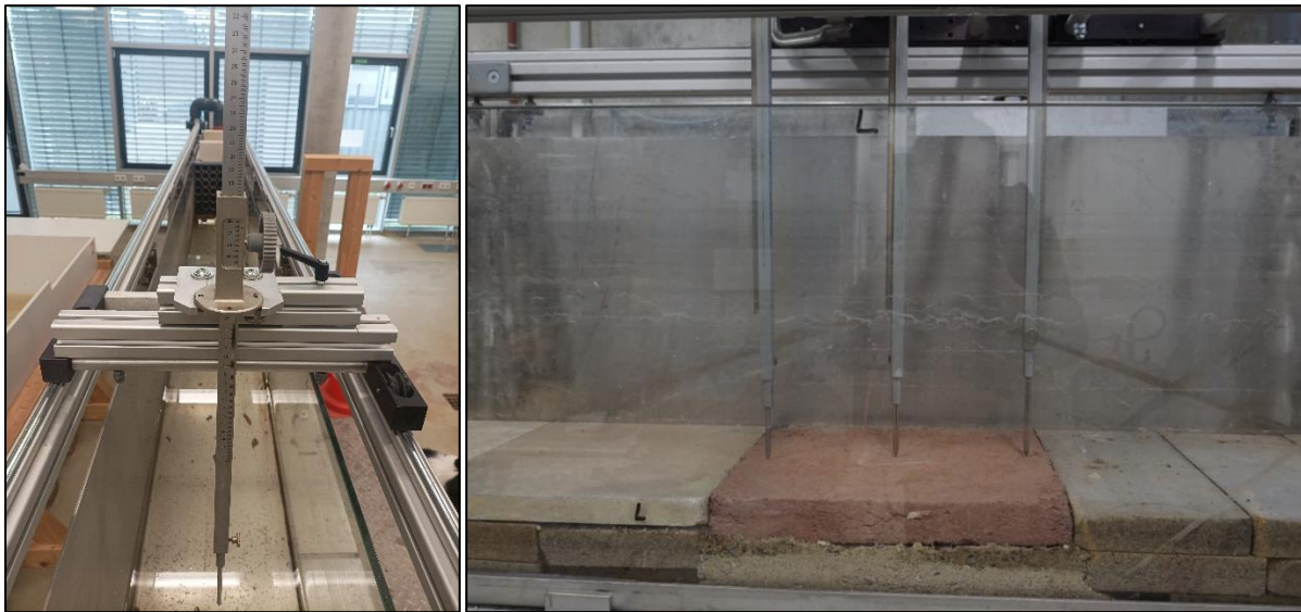
Abb. 4.16: Stechpegel (links), Stechpegel-Anordnung im Versuchsaufbau (rechts) [Bromberg, 2022]
