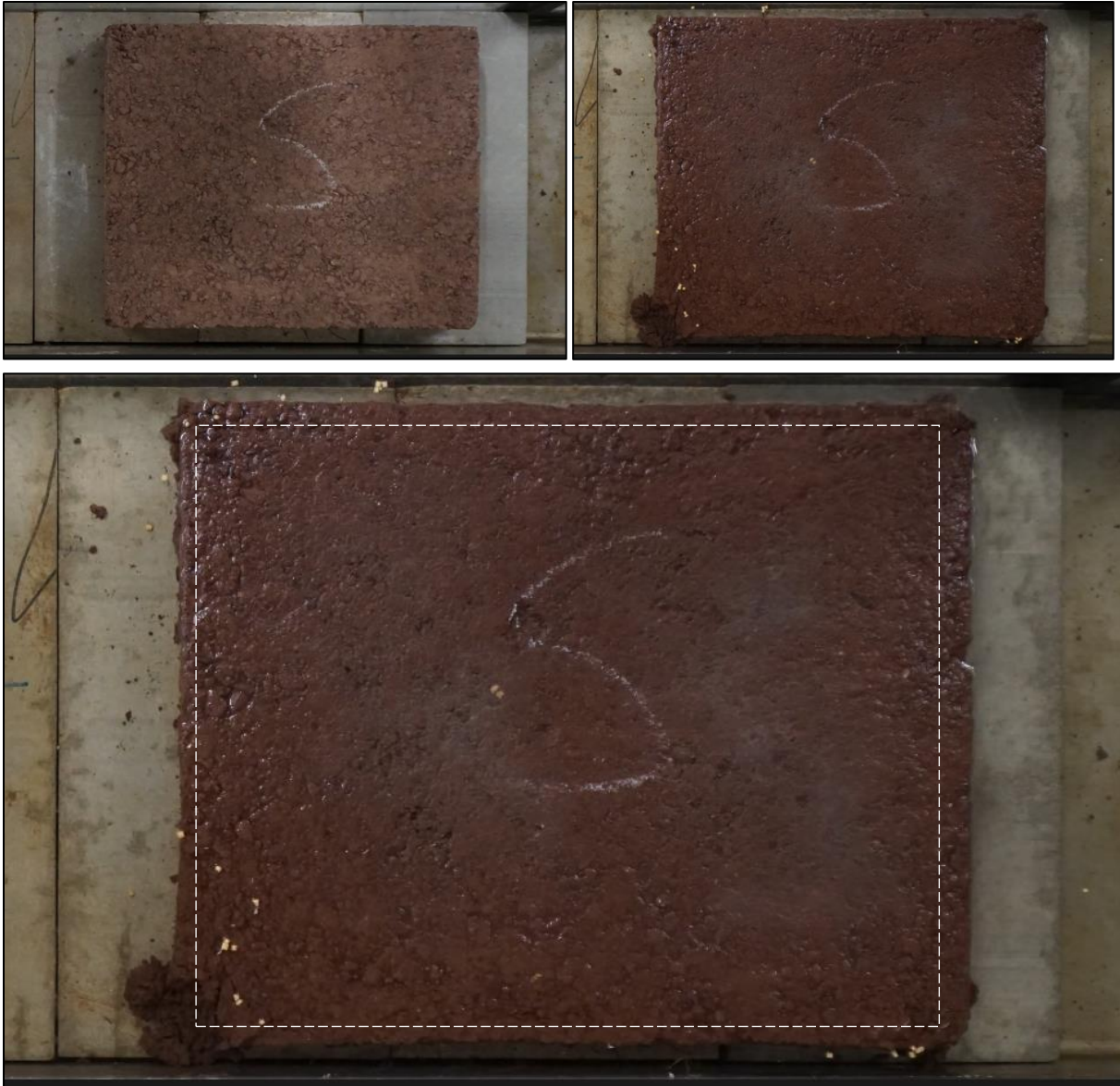
Abb. 5.59: Horizontale Ausdehnung Probekörper UB1 [Bromberg, 2022]
