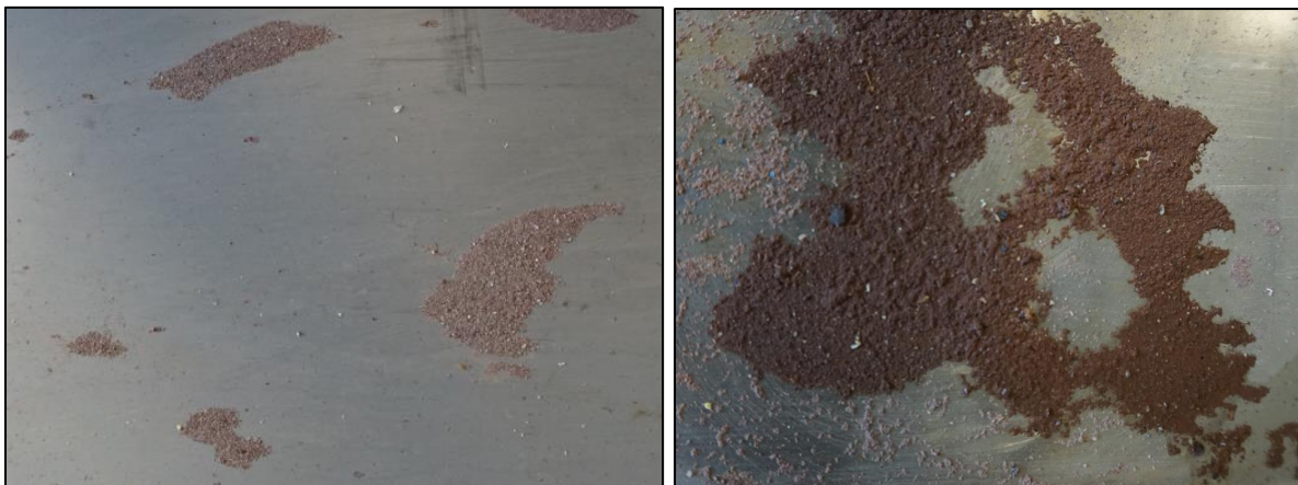
Abb. 5.46: Erodirtes Material nach Versuchsende UB1 [Bromberg, 2022]
