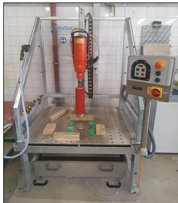
Abb. 3.1: Walzsektorverdichter (links), Kernbohrgerät zum Herausbohren der PK (rechts) [Bromberg, 2021]
