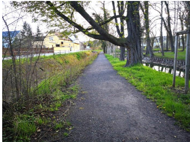
Abb. 36 Gutspark Großjena, wassergebundene Deckschicht, ohne Wegekanten, schlecht belüftete Bereiche durch dicht anstehende hohe Vegetation. Vegetationsübergreif, im hinteren Bereich, bei niedriger Hecke kommt es zu einer besseren Belüftung und kein Ausbreiten der Vegetationsfläche auf den Weg (Zötzl, 2021)
