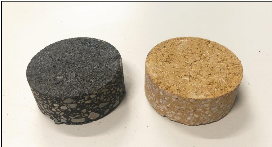
Abb. 3.2: Probekörper der Baustoffgemische BB1 und BB2 [Bromberg, 2021]
