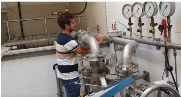
Abbildung 7 Einbau des Prototypen auf dem Prüfstand
