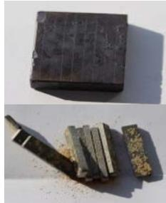
dauer (z.B. 400°/30 min) gelingt dies nicht oder unvollständig. Auf den Magneten bleiben in diesen Fällen erhebliche Mengen Kleber zurück oder polymerbeschichtete Magnete verkleben zu Paketen (vgl. Abbildung 8 oben). Bei 500° Glüh­temperatur und 90 Minuten Haltezeit brennt die Organik dagegen weitgehend vollständig ab und die Magnete liegen vereinzelt vor (vgl. Abbildung 8 unten). Vor der weiteren Verarbeitung werden isolierte Magnete auf einem Sieb von Ascheanhaftungen befreit.
