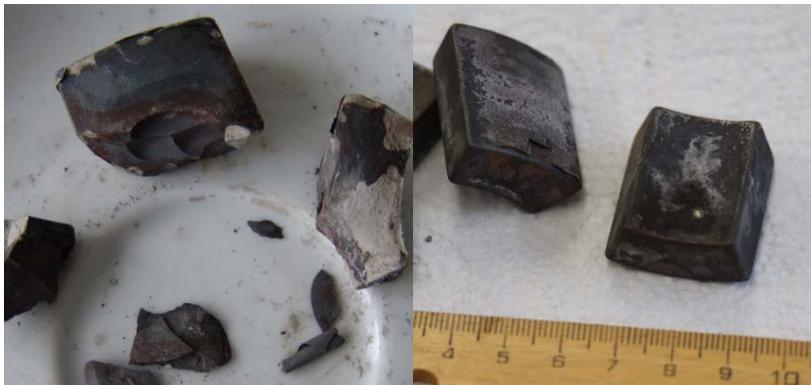
Abbildung 9: Cu/Ni-beschichtete Magnete nach Entmagnetisierung
