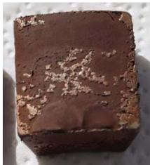
(Abbildung 13). Aufgrund dieses Sachverhalts wurden die Untersuchungen auf in der Galvanotechnik bewährte Stripper ausgedehnt, die selektiv Beschichtungen entfernen sollen ohne das Grundmaterial zu schädigen. Sie basieren meist auf starken Komplexbildnern für die Beschichtungselemente in Kombination mit Inhibitoren, die das Substrat passivieren. Auch diese Agentien erwiesen sich für die stark oxidierten Materialien leider als untauglich.
