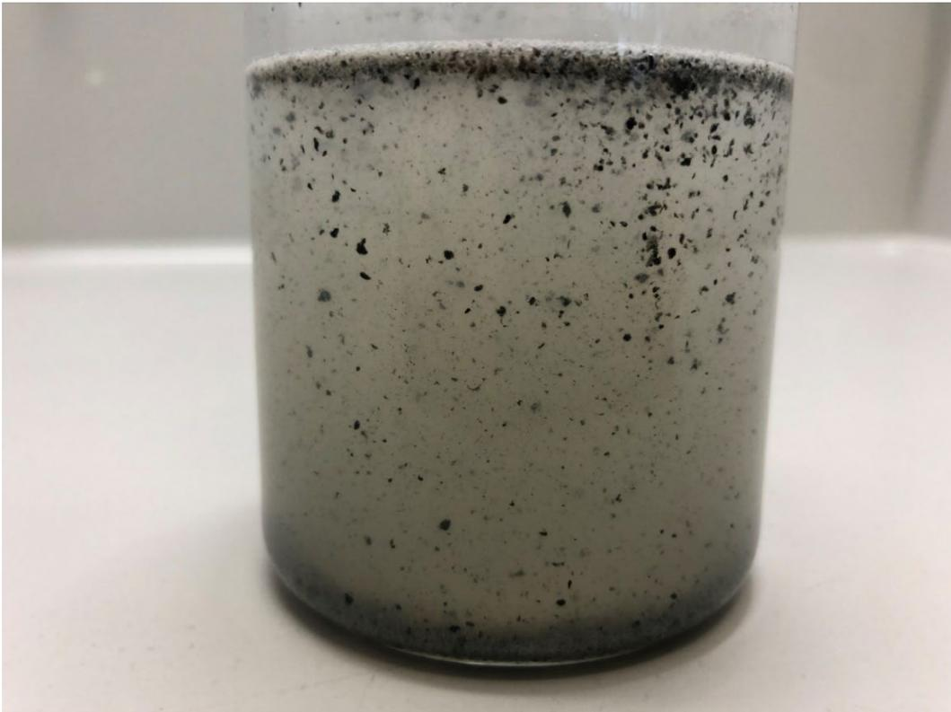
Abbildung 4-16: Probe vom Ablauf des EGSB-Reaktors während des Betriebes von Betriebspunkt 5 in Verfahrenskonzept 2 (HRT  $\sim$  21 h)
