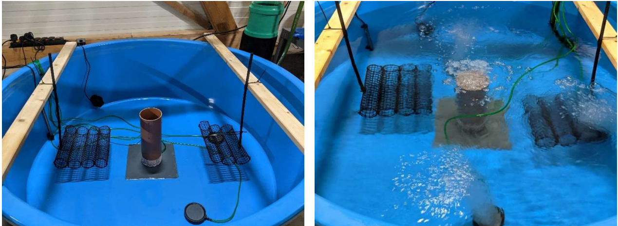
Abbildung 8-2: Habitatversuch: Röhrenstrukturen in einem der sechs Versuchsbecken, rechts: im Testbetrieb blieben die Habitate auch bei eingeschalteter Strömungspumpe ruhig
