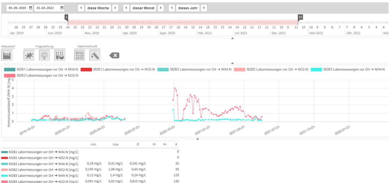
Abbildung 5-28: Delta-Auswertung Modul 2: Verlauf der Konzentration von NH_4-N und NO_2-N in den zwei zwischen September 2019 und März 2022 erfassten GOB (ohne M2B1; Y-Achse gilt auch für NO_2-N [mg/l])
