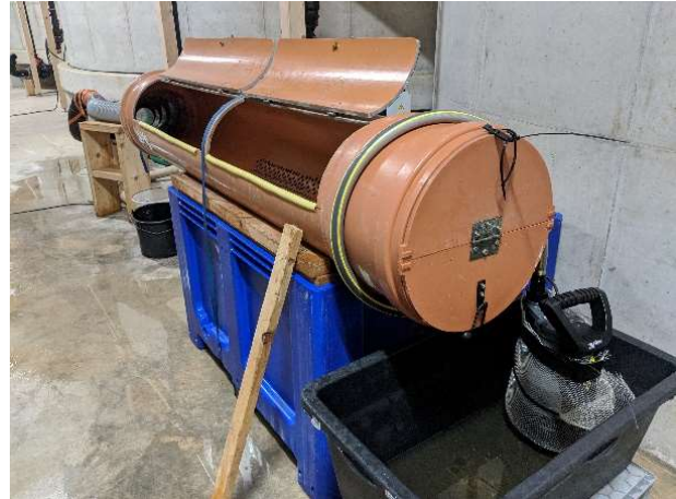
Abbildung 8-23: Prototyp eines Erntemoduls in Betrieb (Anlage Damm Aquakultur)
