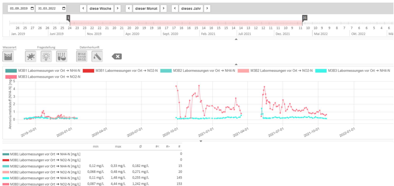
Abbildung 5-29: Delta-Auswertung Modul 3: Verlauf der Konzentration von NH 4 -N und NO 2 -N in den zwei zwischen September 2019 und März 2022 untersuchten GOB (ohne M3B1; Y-Achse gilt auch für NO 2 -N [mg/l])
