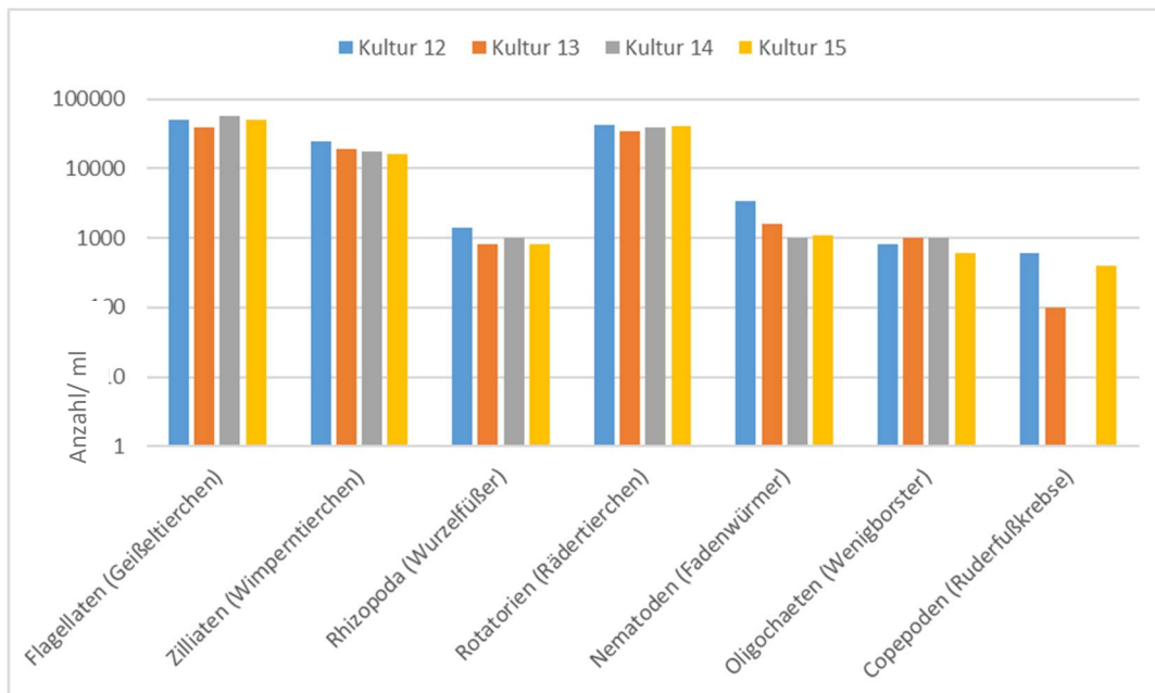
Abbildung 6-2: Meiofauna Vergleich: logarithmische Darstellung der Mittelwerte der in den Flockenproben nachgewiesenen Tierklassen und –ordnungen im Vergleich von vier untersuchten Kulturen (Mittelwerte pro ml Anlagenwasser)
