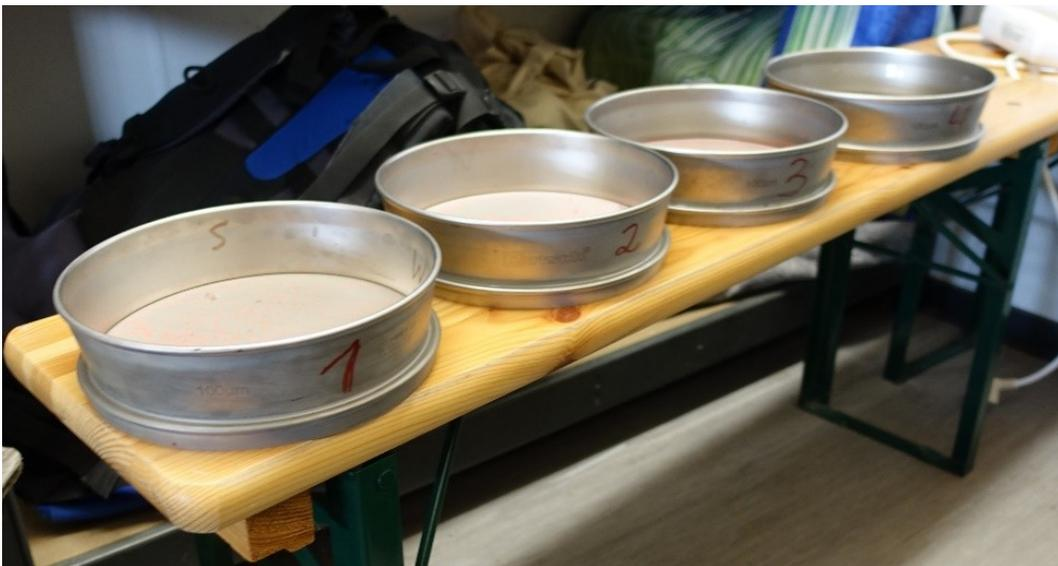
Abb. 20: Abbildung der verwendeten Analysesiebe jeweils bereist mit Testpartikeln
