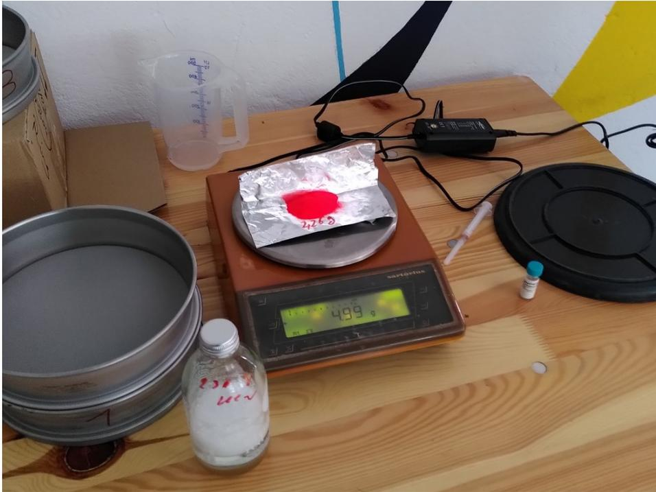
Abb. 21: Einwaage der Testpartikel
