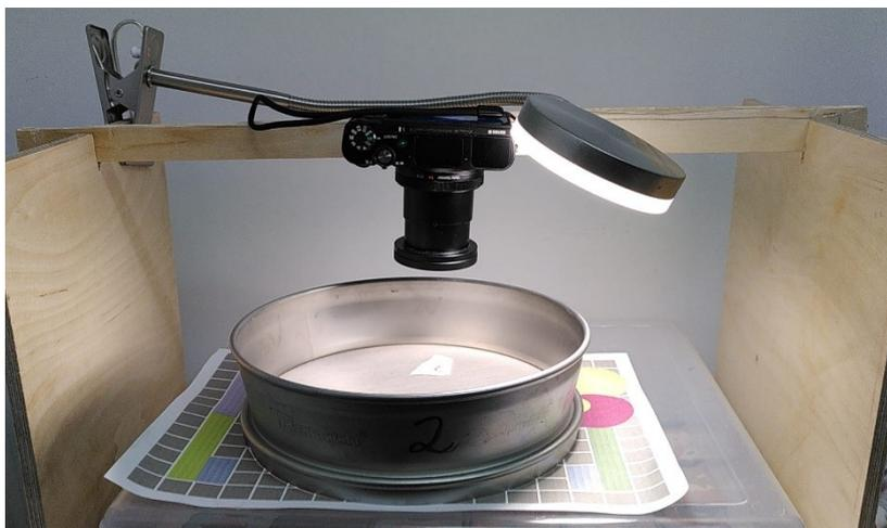
Abb. 22: Aufnahmevorrichtung für die Nahaufnahmen der Testsiebes
