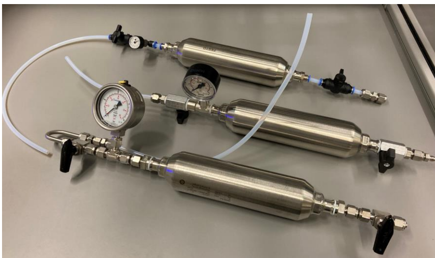
Abbildung 26: Alle drei aufgebauten Kalibriervolumina. Es wurde eine reine metall-/PTFE-gedichtete Edelstahl-Version (unten), eine Metall-Version mit verschiedenen Dichtungsmaterialien (Mitte) und eine Version aus kunststoffbasierten Pneumatik-Bauteilen (hinten) aufgebaut.
