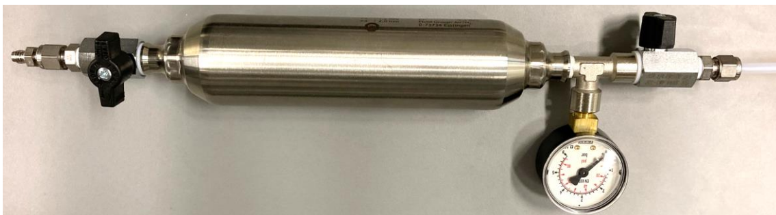
Abbildung 23: Eines der aufgebauten Kalibriervolumina („Metall-Version“). Der Druckluftspeicher ist mit einem Barometer versehen und kann beidseitig mit Kugelhähnen verschlossen werden. Ein Ende ist mit dem passenden Schlauch zum Anschließen an den Demonstrator versehen.
