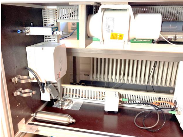
Abbildung 25: Halterung (links) und Anschluss (blau, am Massenflussregler links) für die Kalibriervolumina am Demonstrator.
