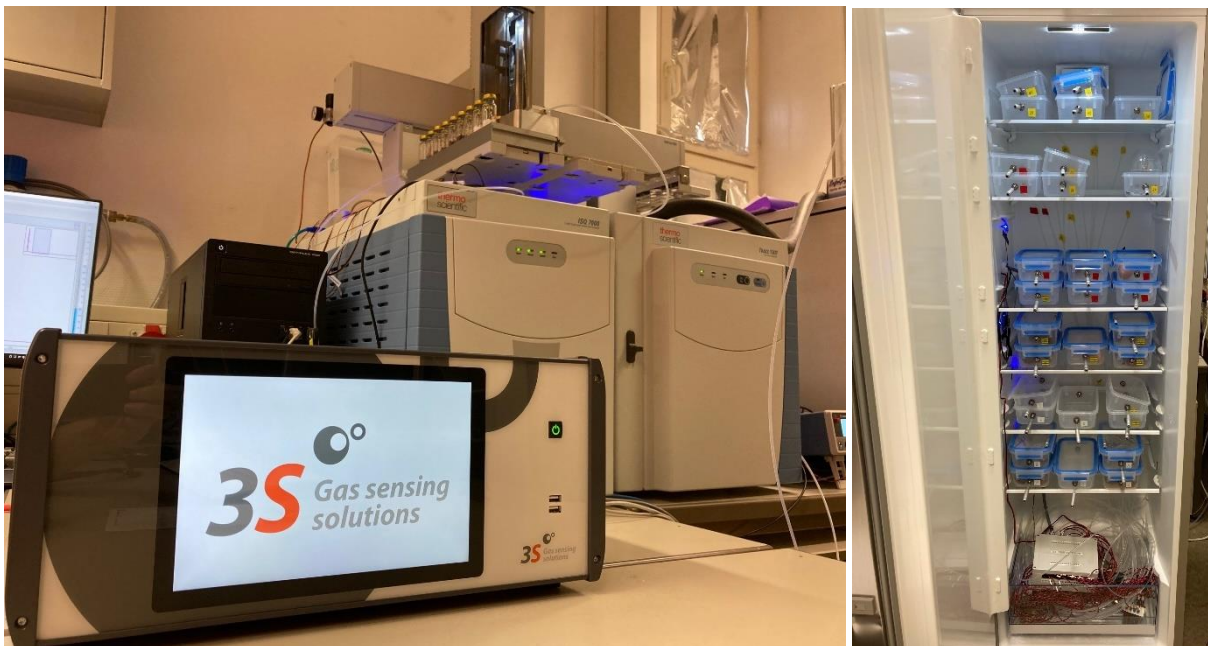
Abbildung 6: links: OCS-Messgerät im Labor vor dem GC-MS des LMT; rechts: Kühlschrank mit Frischeboxen, im untersten Fach befindet sich der zum Messgerät gehörige Multiplexer zur Ventilsteuerung sowie die Ventilblöcke.
