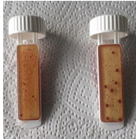
7-2: Vergleich der Gesamtkeimzahl, rechts einfach, links Fritte
