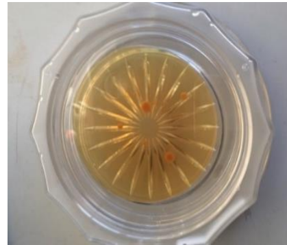
Abb. 5-2 : Nährboden nach 1,5 h Versuchsdauer mit Keimen
