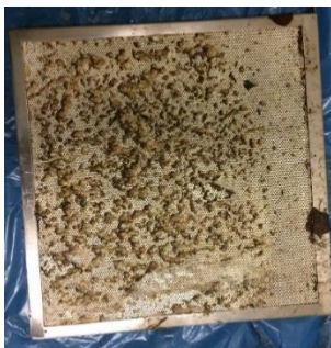
Abb. 2: Ablagerungen auf einem Hygienisierungsmodul mit versilbertem Kupferdraht
