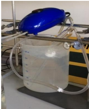
Abb. 5 -1: Keimquelle, unter der Pumpe platziert
