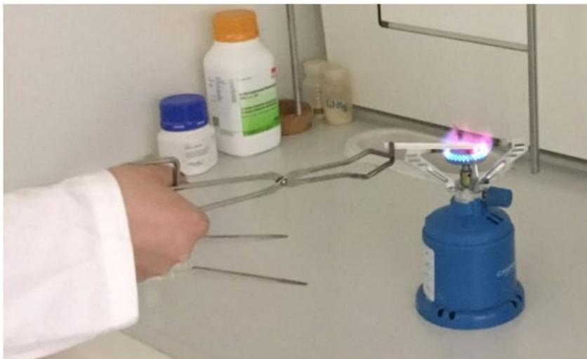
Abbildung 16: Charakteristische rote Flammenfärbung von  $\text{Li}_3\text{PO}_4$ .
