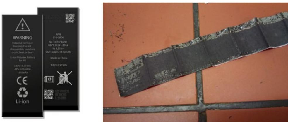
Abbildung 5: Li- Polymer-Akku-Typen: Typ 1 enthält durchgängige Elektroden- und Elektrolytfolien: Vollständiger Akku vor der Entmantelung (links) und Kathodenfolie nach der Entmantelung (rechts).
