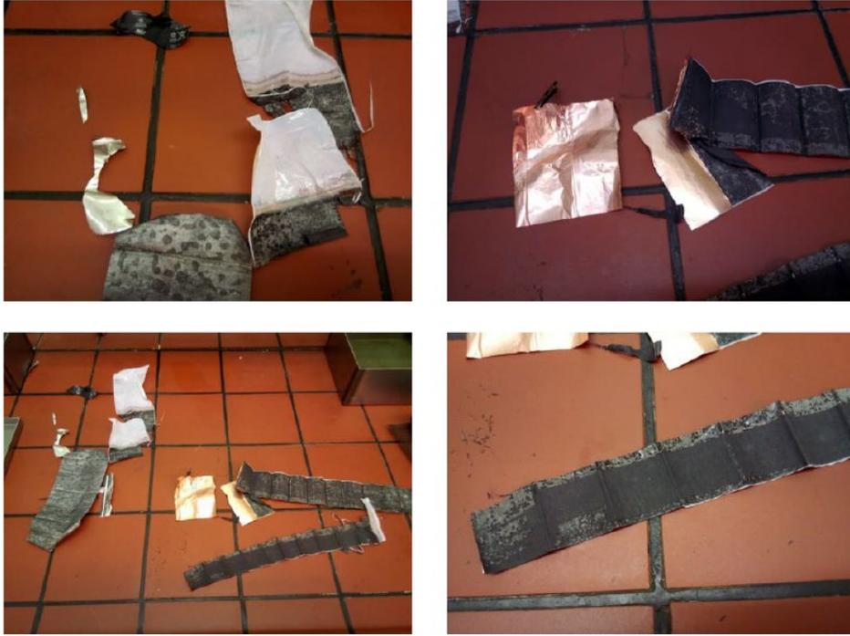
Abbildung 8: Übersicht verschiedener Materialklassen nach der Entmantelung eines Li-Polymer-Akkus eines iPhones.
