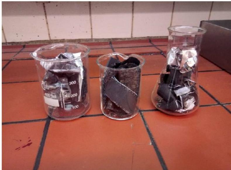
Abbildung 9: Sortierung der verschiedenen Materialklassen nach der Entmantelung eines Li-Polymer-Akkus eines iPhones. (links). Kathodenmaterial aus Aluminium; (Mitte) Anodenmaterial aus Kupfer; (rechts) Plastikabfälle, Kontakte und Separator- und Elektrolytfolien.
