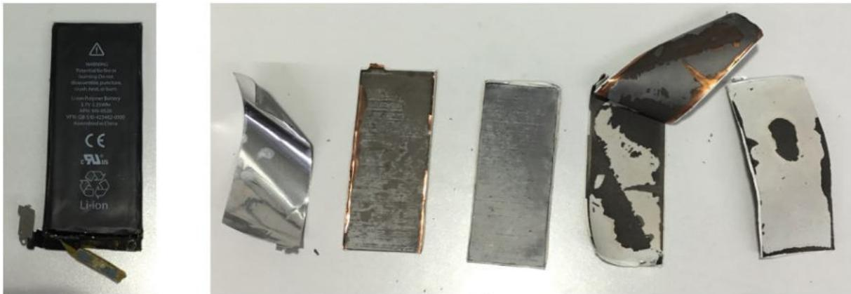
Abbildung 6: Li-Polymer- Akku-Typen: Typ 2 enthält mehrere Elektrodeneinheiten. Vollständiger Akku vor der Entmantelung (links) und einzelne Elektrodeneinheiten nach der Entmantelung (rechts).
