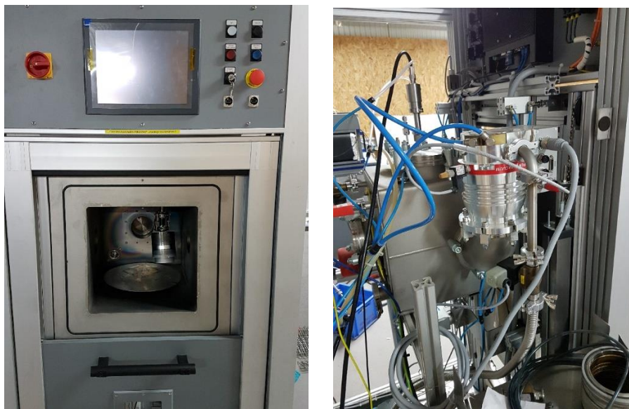
Abbildung 1: Versuchsanlage mit integrierter Turbopumpe (rechts)
