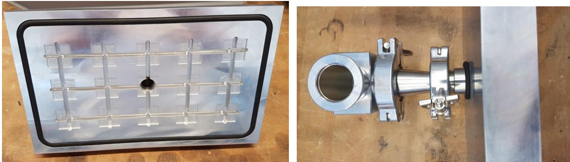
Abbildung 10: Versuchswerkzeug zur Simulation von Tiefziehverarbeitungen der beschichteten Muster
