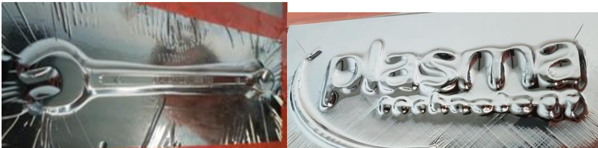
Abbildung 11: Versuchswerkzeug zur grundlegenden Vorbewertung des Umformverhaltens der beschichteten Muster - die Ergebnisse der „Tiefziehversuche“ zeigten unabhängig von den unterschiedlichen Umformeigenschaften der Proben eine insgesamt gute Beständigkeit der optischen Oberflächeneigenschaften nach der Umformung
