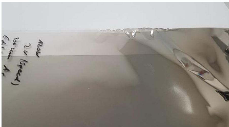
Abbildung 7: Bei variiert Wickelgeschwindigkeit erzeugte Beschichtungsprobe (Dichte der Schicht steigt von links nach rechts; Durchsichtigkeit sinkt von links nach rechts)
