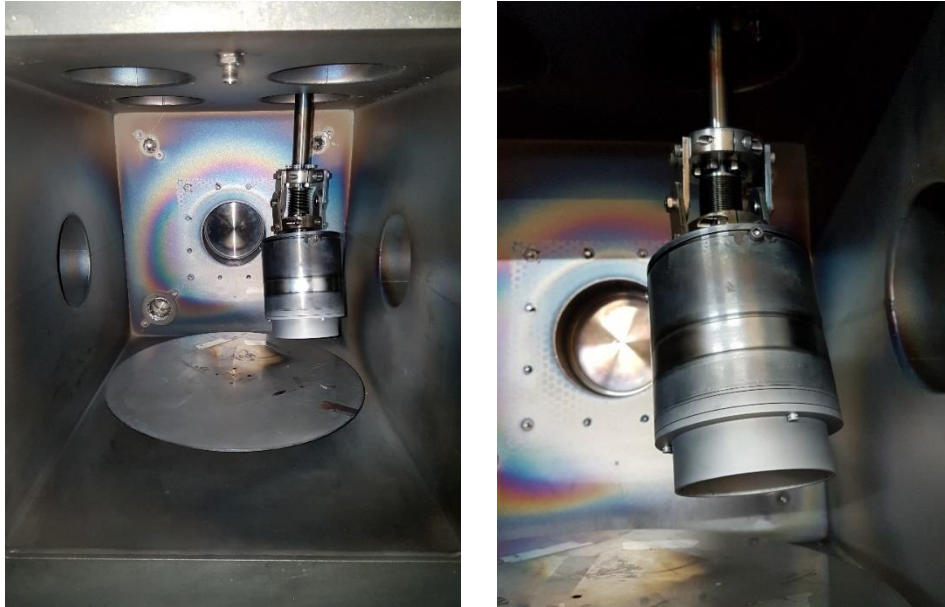
Abbildung 2: Drehteller für die rotierende Substratlagerung (links) und schwenkbare Aufnahme des PVD-Targets
