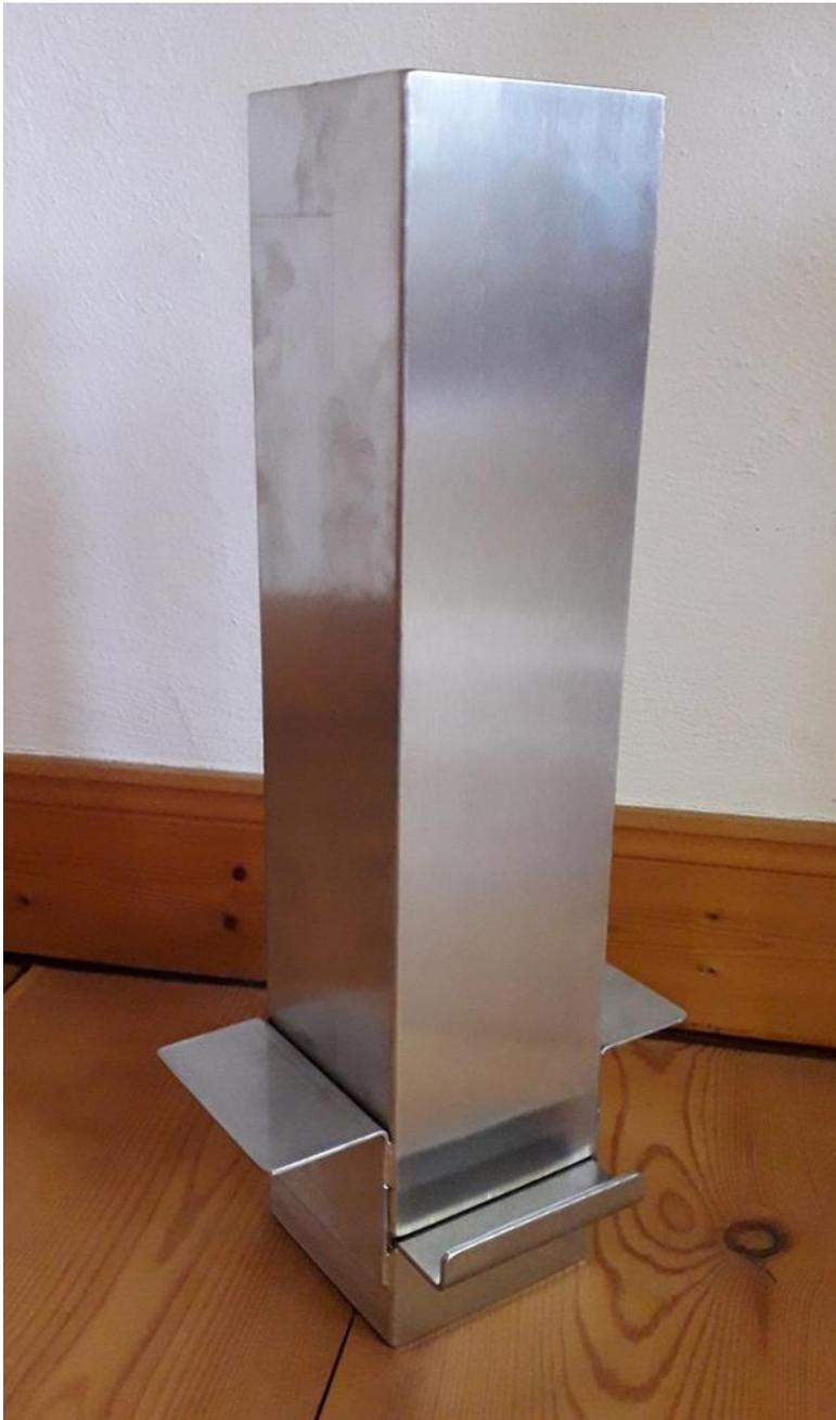
**Abbildung 2:** Benthos-Stechkasten, eine Sonderanfertigung für dieses Projekt mit einer Volumenentnahme von 10x10x5 cm (500 cm<sup>3</sup>). Der Stechkasten wird 10 cm in den Gewässergrund hineingesteckt und mit Hilfe des seitlichen Schiebers werden die obersten 5 cm des Benthos abgetrennt und die Probe kann so entnommen werden.
