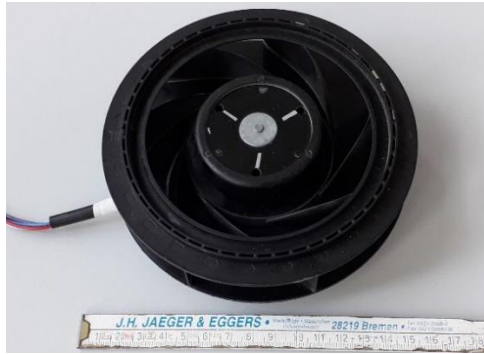
Abbildung 6: ausgewählter RER140-22/14N/2TDP von ebm-papst für Prototyp I
