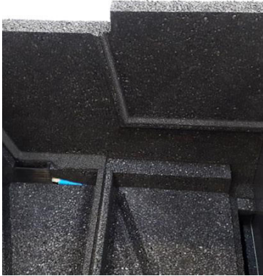
Abbildung 37: Innenansicht des Prototyp II ohne Wärmetauscher und Schalldämpfer
