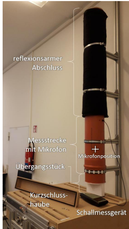
Abbildung 15: Messaufbau für Kanalschallmessungen am Prototyp I
