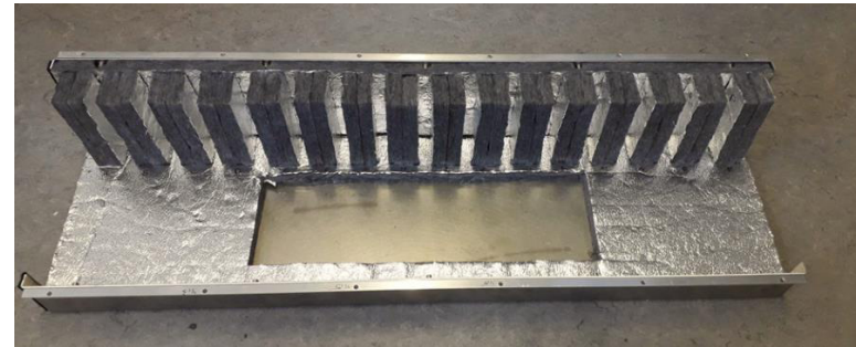
Abbildung 19: komplett mit Schalldämmmaterial ausgekleidete Kanalwand inkl. Schallkulissen
