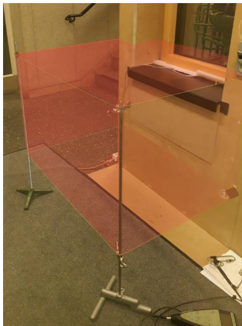
Abbildung 41: Messaufbau für Schallmessungen am Prototyp II nach dem Intensitätsverfahren
