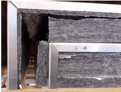
Abbildung 16: Komplettauskleidung der Kanäle, Seitenansicht
