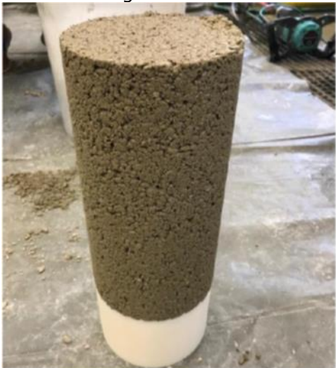
Abbildung 17: Ausgeschalteter Referenzbeton nach der Instron-Verdichtung
