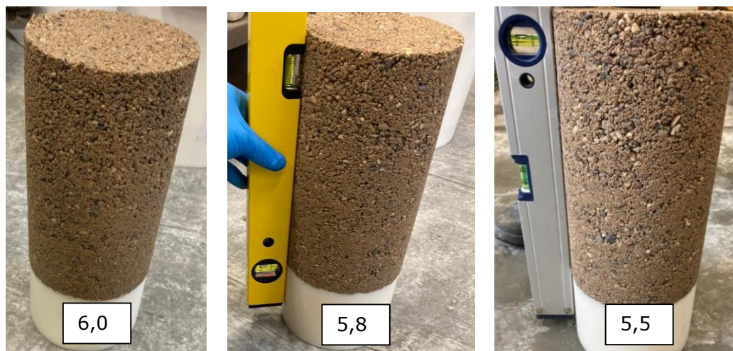
Abbildung 29: Favorisierte Betonproben der Versuchsreihe 03.02 nach dem Ausschalen mit G/BMG-Verhältnissen von 6,0; 5,8; 5,5
