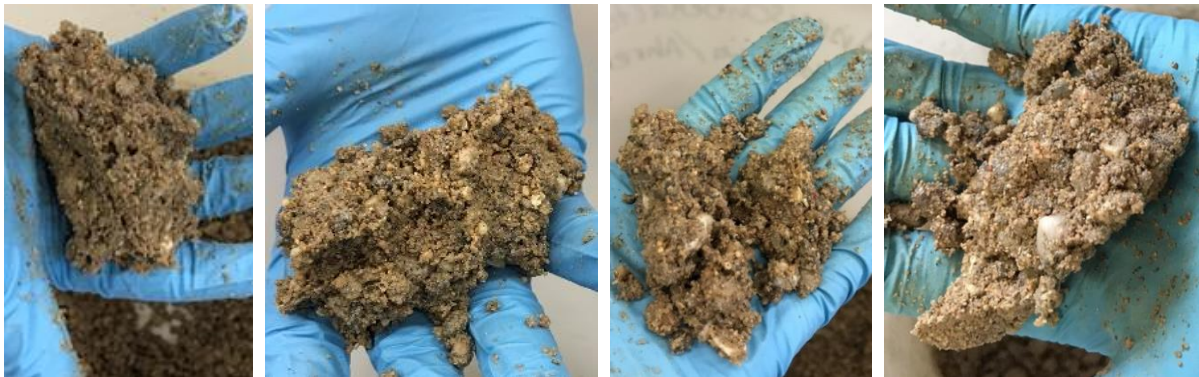
Abbildung 27: Knetversuch der Versuchsreihen Beton Nr.2 (von links nach rechts) 1,1_5,0; 0,9_5,6; 1,3_5,9; 1,0_5,6
