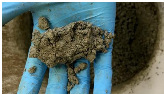
Abbildung 16: Konsistenz des Referenzbetons nach Zusammendrücken in der Faust
