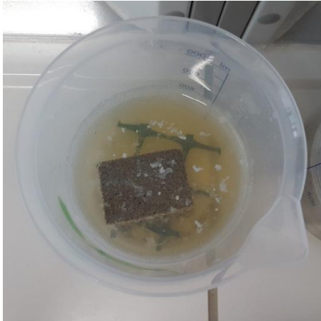
Abbildung 6: 28 Tage alter Betonbrechsandmörtel nach 14-tägiger Wasserlagerung
