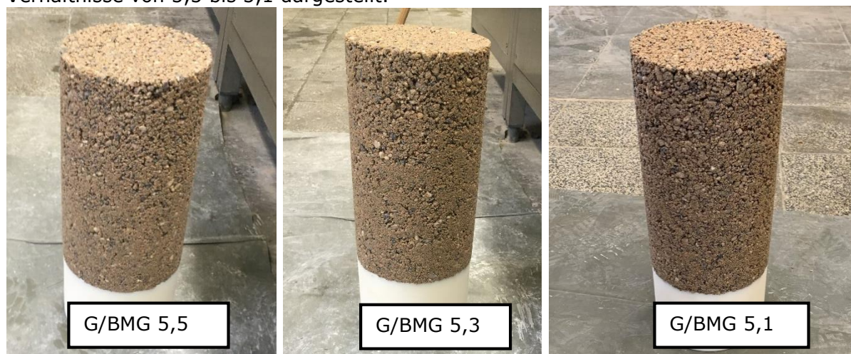
Abbildung 21: Versuchsreihe 01.01: Betonproben direkt nach dem Ausschalen (links: 5,5; mittig: 5,3; rechts: 5,1)
