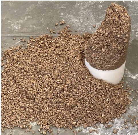
Abbildung 28: Zusammengefallener Beton WGM1,9_40/60_1,1_6,3 nach dem Ausschalen
