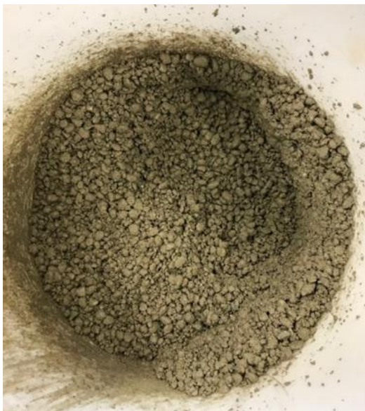
Abbildung 15: Konsistenz des Referenzbetons nach dem Anmischen
