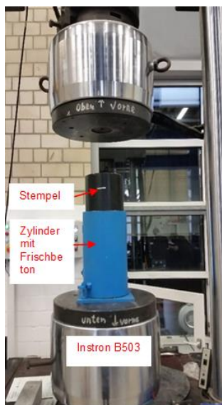
Abbildung 13: Verdichtung mittels Instron B503
