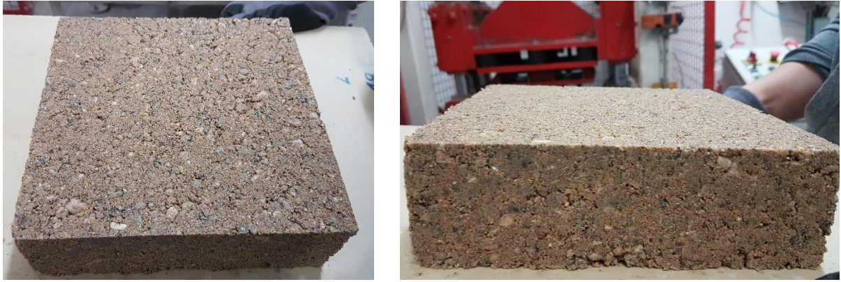
Abbildung 35: Auf- (links) und Seitenansicht (rechts) eines Pflastersteinprototyps direkt nach dem Ausschalen
