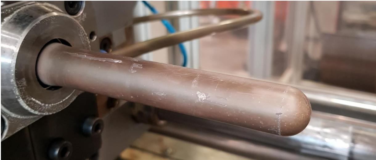
Bild 25: beschichteter Formkern mit Spuren der Schichtablösung
