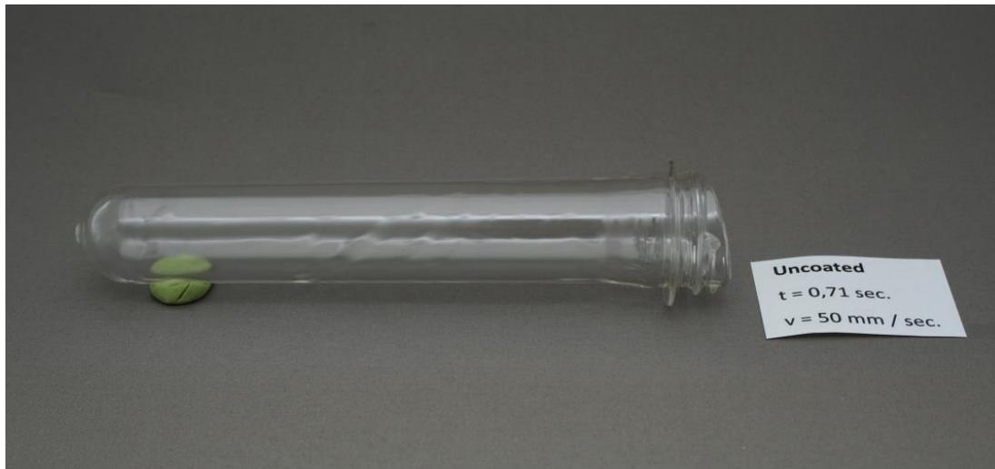
Bild 27: Teilausgeformter PET Preform aus unbeschichtetem Werkzeug
