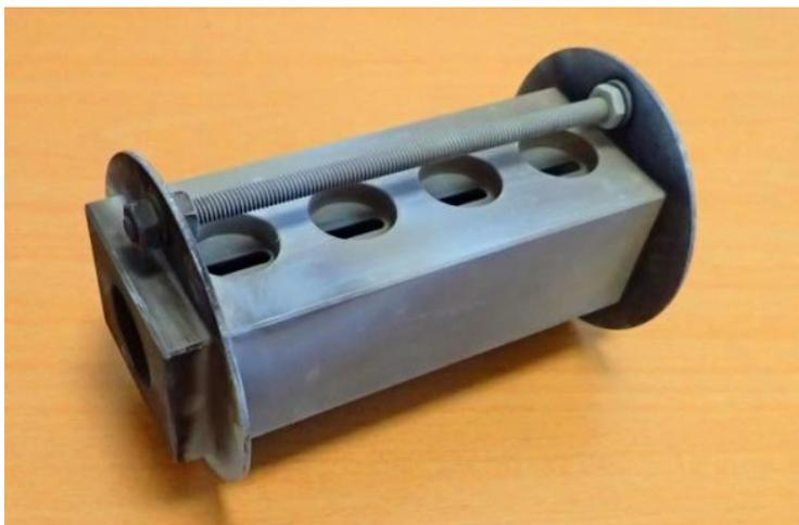
Bild 13: Leitblech zur Stoffkonzentration im CVD Beschichtungsprozess
