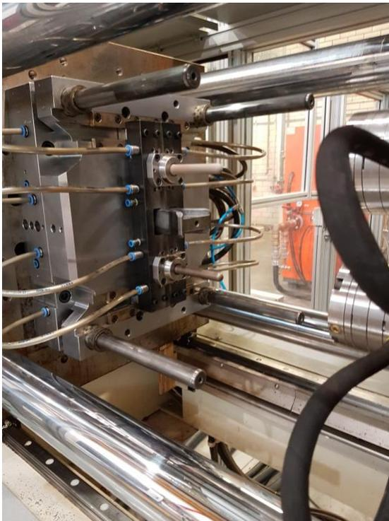
Bild 24: 2-fach Spritzgießwerkzeug mit jeweils beschichteten (oben) und unbeschichteten Formteilen (unten)
