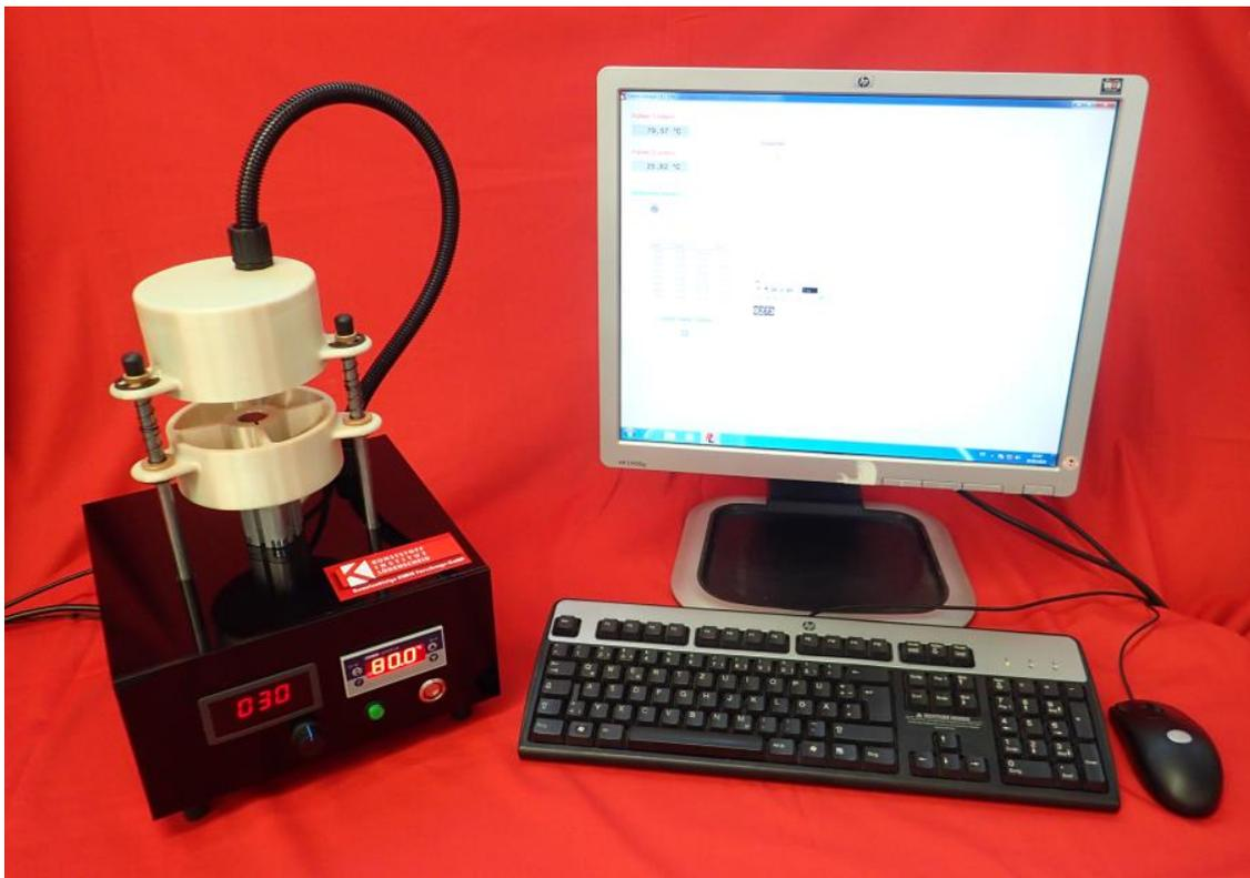
Bild 2: Wärmeleitprüfstand zur Bestimmung des Wärmeeindringindex in Bauteiloberflächen
