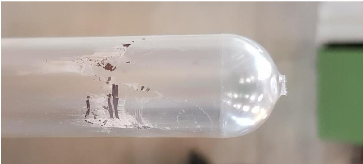
Bild 26: Vorformling mit Rückständen der abgelösten Beschichtung
