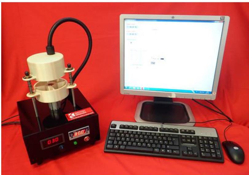
Bild 20: Entwickelter Wärmeleitprüfstand zur Bestimmung der Wärmeeindringfähigkeit
