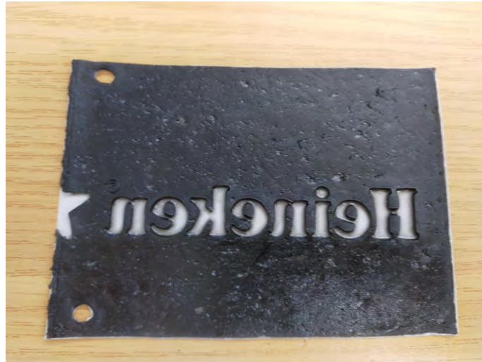
Abbildung 20: Belichtete, ausgewaschen und getrocknete Destillatplatte mit Schriftzug
