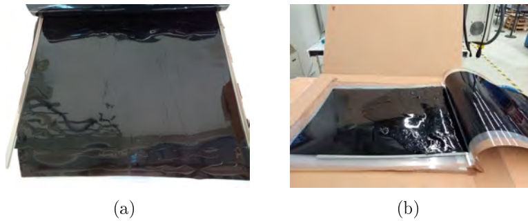
Abbildung 5: Beispielhaft aufgetretene Formatunterschiede der Destillatplatten (Zustand 1). 1 (a) Format: ca. 51 cm x 48 cm und 9 (b) Format: ca. 48 cm x 42 cm
