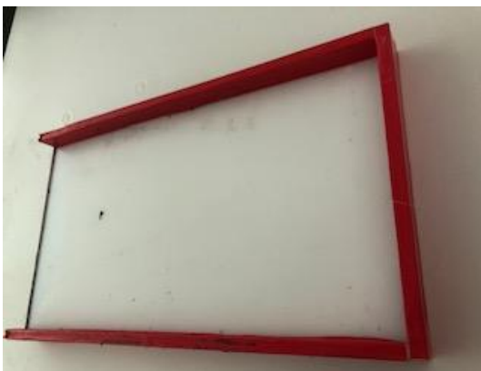
Abb. 8 Gießform für dünne Platten
