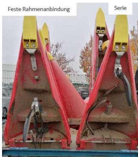
Abbildung 16: Höhenführungssensorik als Bodentastbügel
