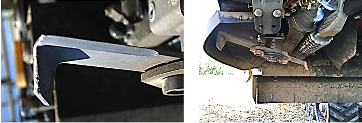
Abbildung 9: Erste Generation der Hybridmesser des HS3 zur Ernte 2018
