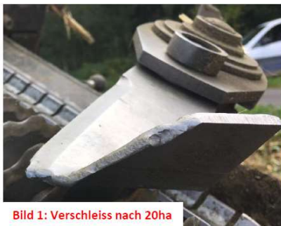
Abbildung 10: Verschleißzustand der Hybridmesser der ersten Generation in Abhängigkeit von der Einsatzfläche
