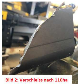
Abbildung 10: Verschleißzustand der Hybridmesser der ersten Generation in Abhängigkeit von der Einsatzfläche
