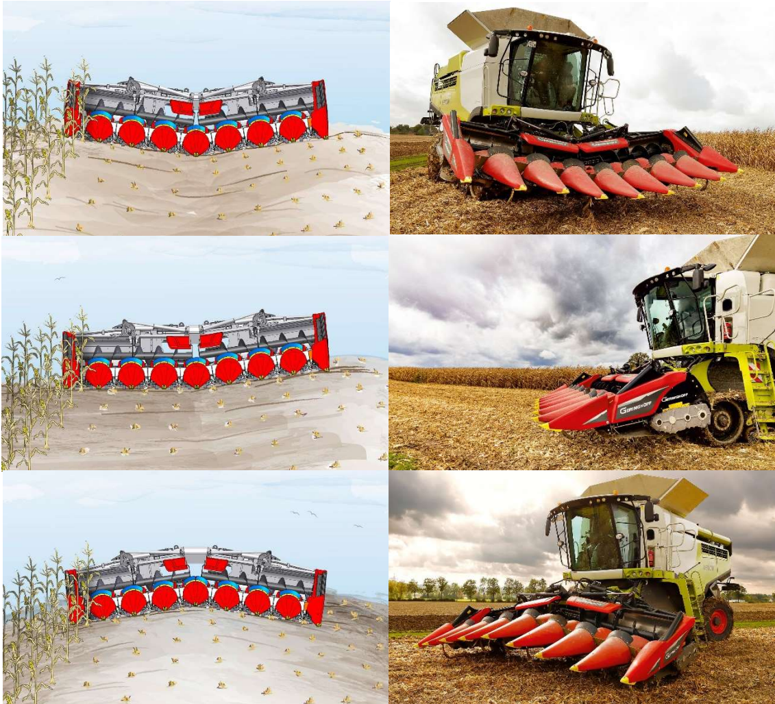
Abbildung 18: Horizon Star III Razor mit geteiltem Grundrahmen
