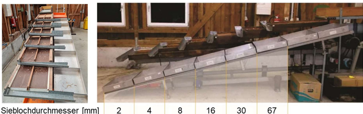
Abbildung 31: Kaskadensiebanlage des Thünen-Instituts für Agrartechnologie (verändert nach VOßHENRICH et al. 2017: 24)
