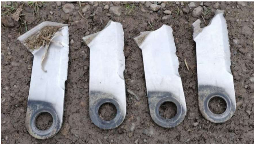
Abbildung 12: Verschleißerscheinungen der Messer der zweiten Generation nach intensivem provoziertem Kontakt mit Fremdkörpern
