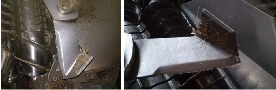
Abbildung 11: Verschleißzustand der Messer der zweiten Generation im Langzeittest auf Feldern mit geringem Steinbesatz, Einsatzfläche ca. 150 ha
