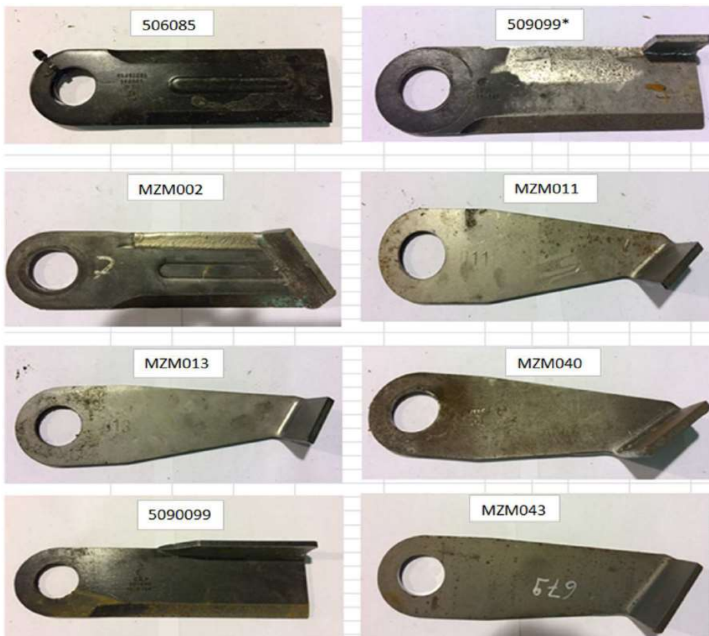
Abbildung 6: Prototypen von Werkzeugen mit unterschiedlichen Geometrien
