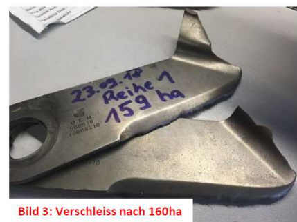
Abbildung 10: Verschleißzustand der Hybridmesser der ersten Generation in Abhängigkeit von der Einsatzfläche
