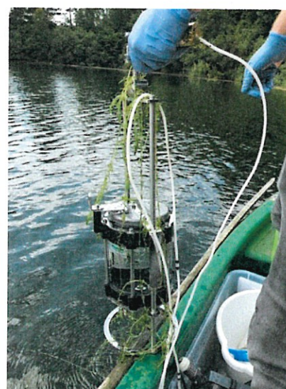
Abbildung 17: Probenahme in der Wassersäule [ISA]
