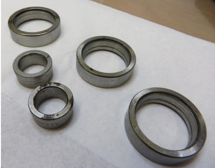
Abbildung 20: Korrosionsspuren nach 44 Tagen, Variante 3
