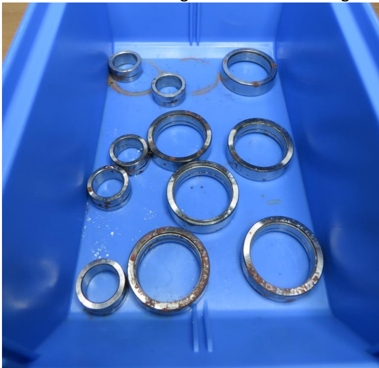
Abbildung 19: Korrosionsspuren nach 25 Tagen, Variante 2
