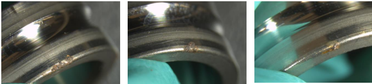
Abbildung 16: Korrosionsspuren nach 25 Tagen, Variante 1
