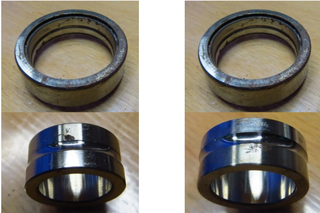
Abbildung 18: Korrosionsspuren nach 5 Tagen, Variante 2
