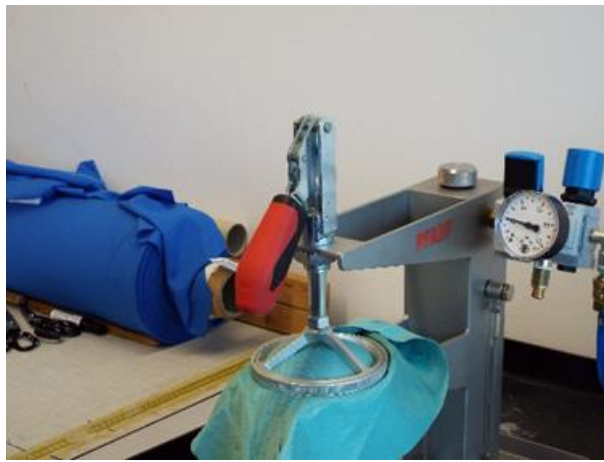
Abbildung 6: Nahtprüfstation von Pfaff mit einem mit Wasserdruck beaufschlagten Prüfling. Die Bearbeitung dieses Arbeitspaketes erfolgte von Trans Textil.
