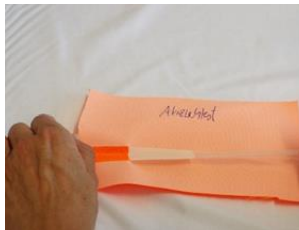
Abbildung 5: Erfolgreicher Abziehtest von Tapes auf einem textilen Laminat nach dem Tappen.
