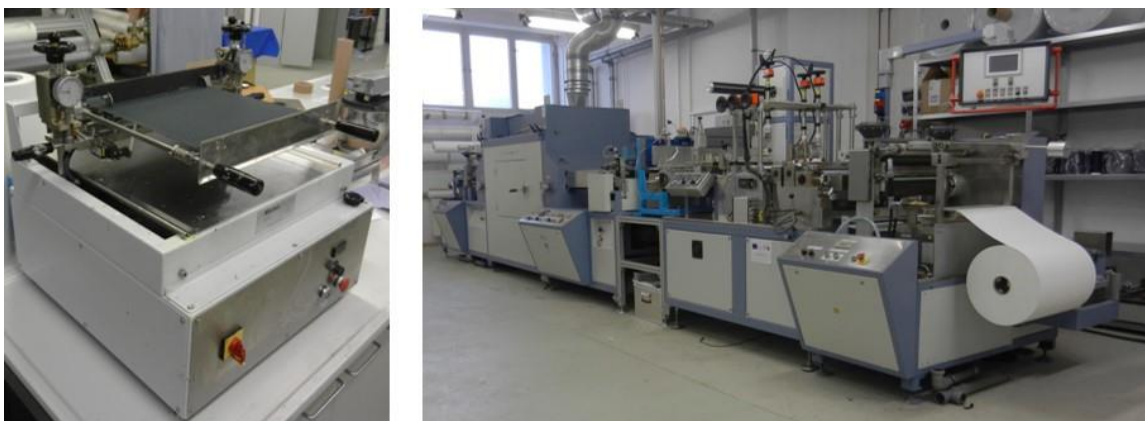
Abbildung 3: Fotos des Handstreichgerätes (links) und der Laborbeschichtungsanlage (rechts).
