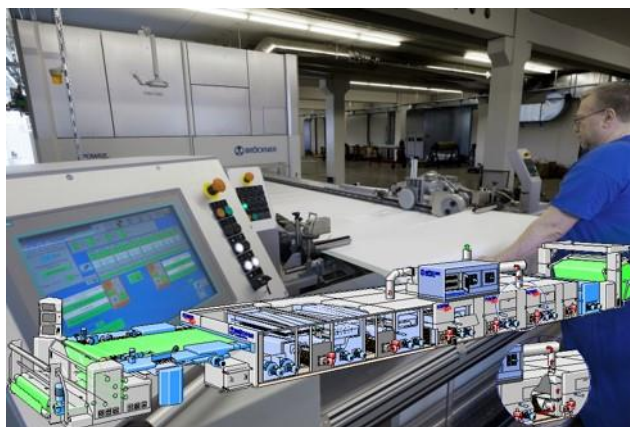
Abbildung 7: Foto und Schema der Beschichtungsanlage der Firma Trans-Textil GmbH, Freilassing.
