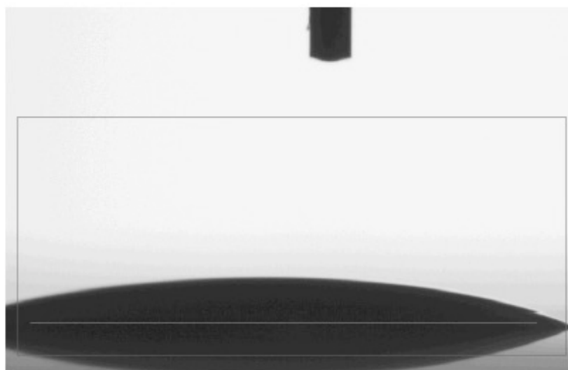
Abbildung 19: Kontaktwinkelmessung einer Titanprobe nach Verwendung von Waschmittel.
