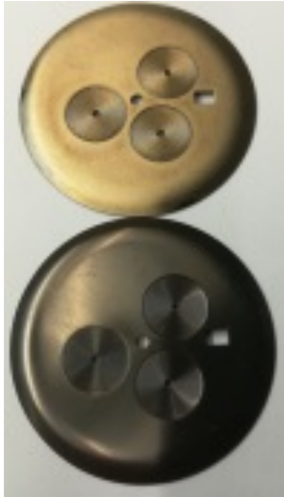
Abbildung 30: Test lasermodifiziertes Schwarznickel Zifferblatt (Ergebnis: goldfarbenes Zifferblatt)
