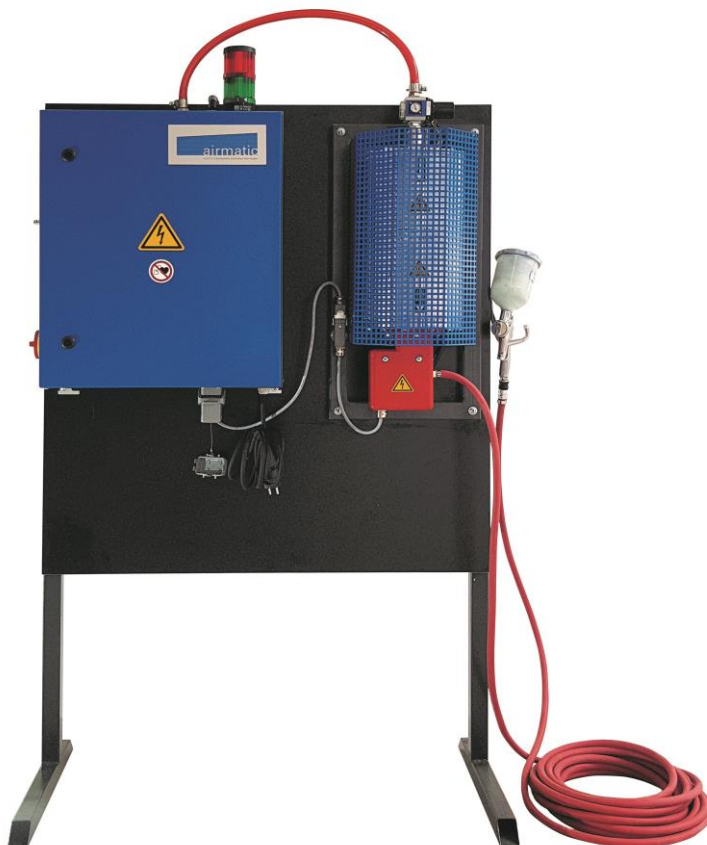
Abbildung 20: Gesamtansicht des Systems. Heizsystem ist dem Hochspannungs-System nachgeschaltet
