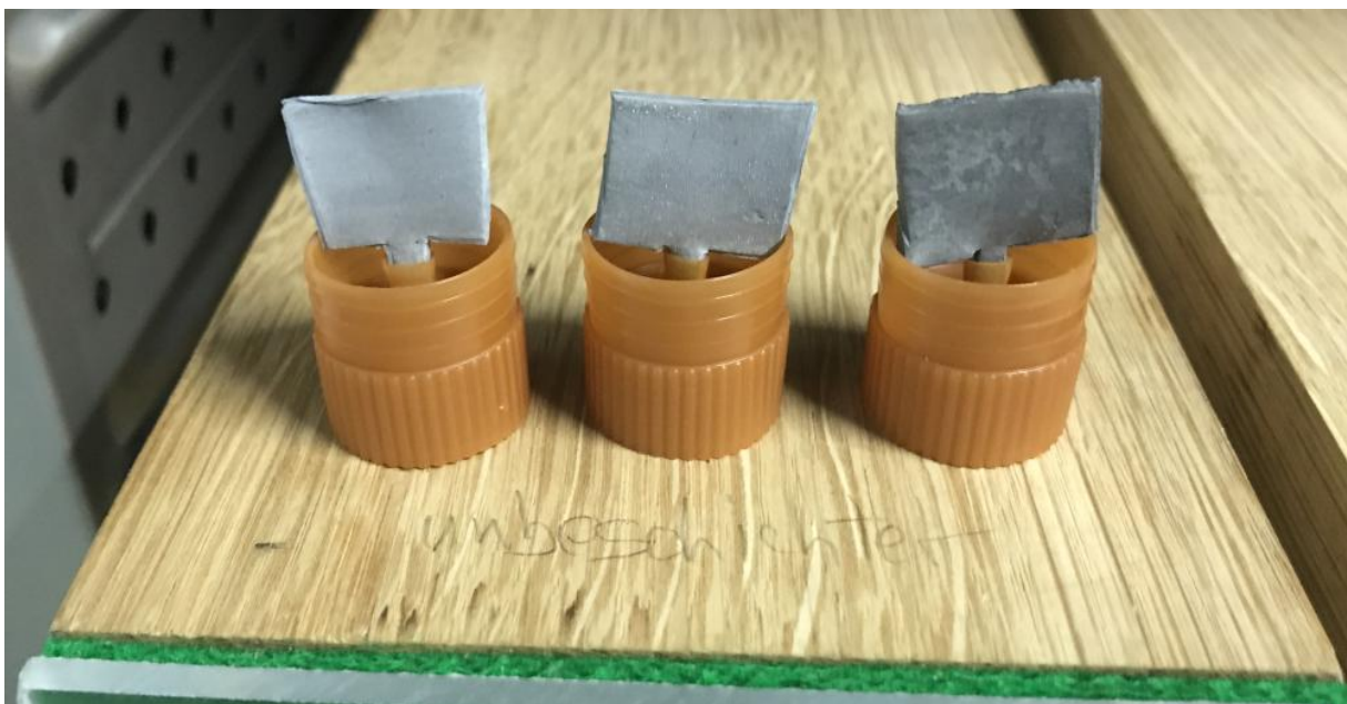
Abb. 46: Ergebnis der Auslagerung von Bleicoupon während der Korrosionsversuche links: unbeschichtete Kanzelle, mitte: mit Kreide beschichtet, rechts: mit Kalk beschichtet
