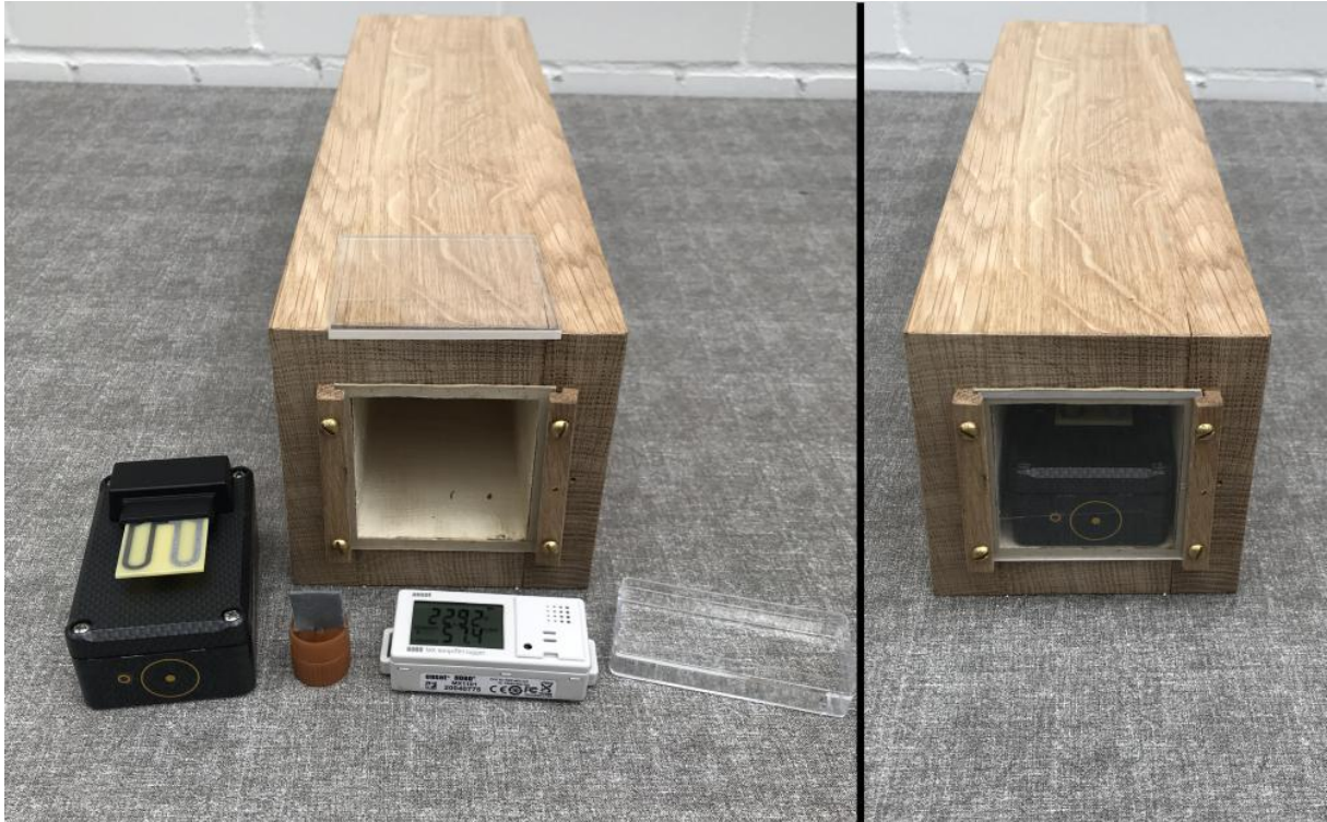
Abb. 43: Versuchsaufbau einer Probekanzelle: Wasserschälchen, HOBO Feuchte-/Temperatursensor, ein Bleicoupon, AirCorr-Messsystem mit Bleisensor
