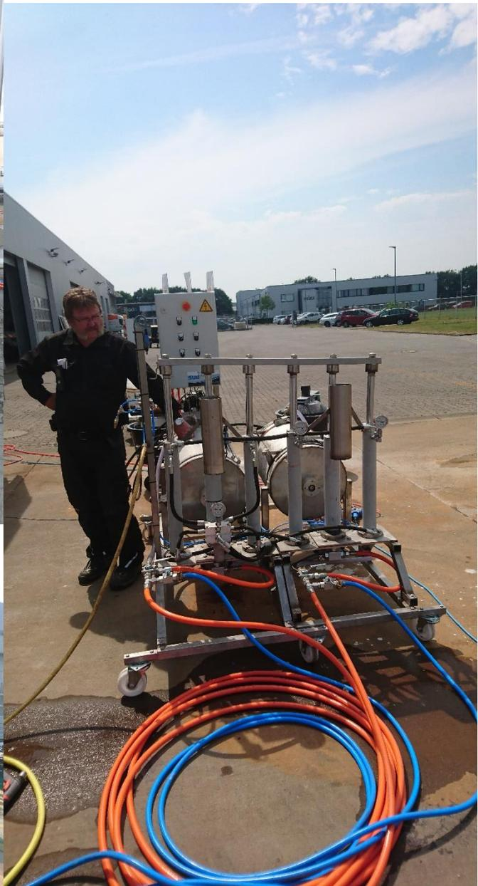
**Abbildung 6-17: Bevorratungs- und Pumptechnik mit Anschlüssen an den Sanierungsanhänger**
