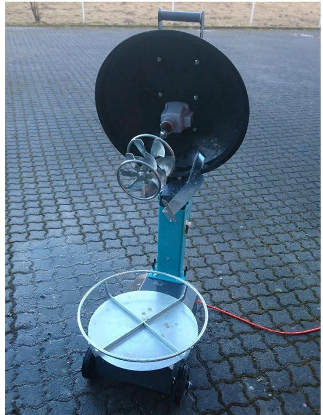
Abbildung 1-2: Collomix Rotationsmischer, Mischwerkzeug und Drehteller
