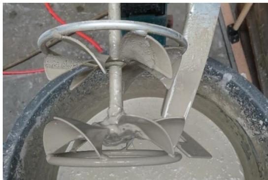
**Abbildung 5-3: Rotationsmischer-Mischer nach dem Vermischen der Z-Komponente**
