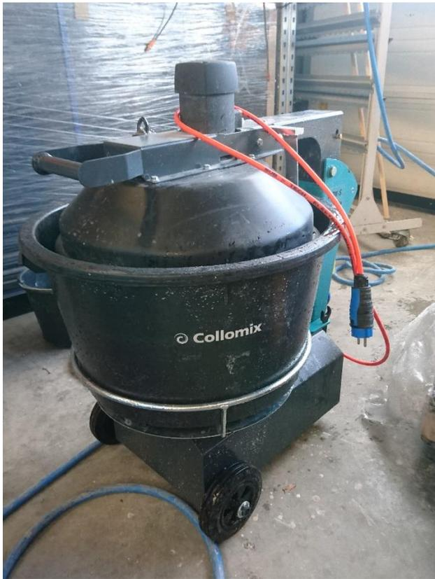
Abbildung 1-1: Collomix Rotationsmischer AOX-S im geschlossenen Zustand
