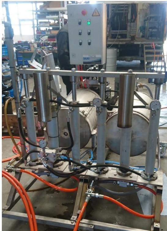
**Abbildung 1-6: Fertiggestellte zweiteilige Bevorratungs und Pumpmaschine für beide Komponenten**
