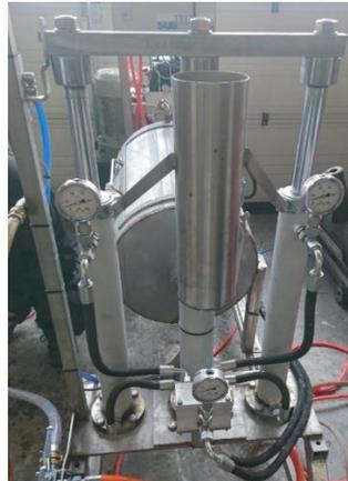
**Abbildung 1-5: Einteilige Bevorratungs- und Pumpmaschine für eine Komponente**
