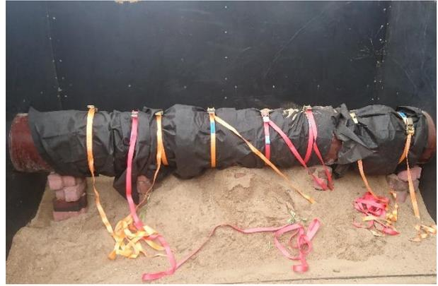
**Abbildung 6-12: mit Vlies umwickelt und verspannte Rohrschäden (5-8)**
