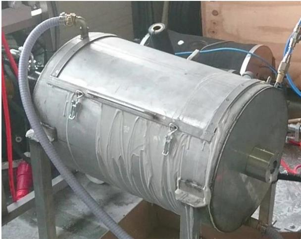
**Abbildung 5-4: Bevorratungsbehälter mit Hartgummidichtung**
