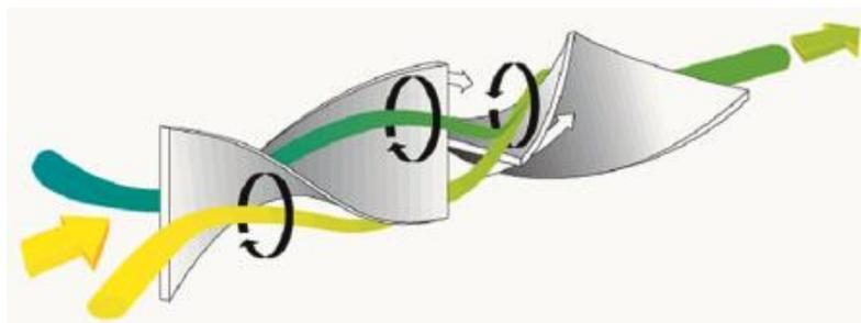
**Abbildung 1-11: Wirkungsprinzip eines Wendelmischer nach BERNHARDT [7]**
