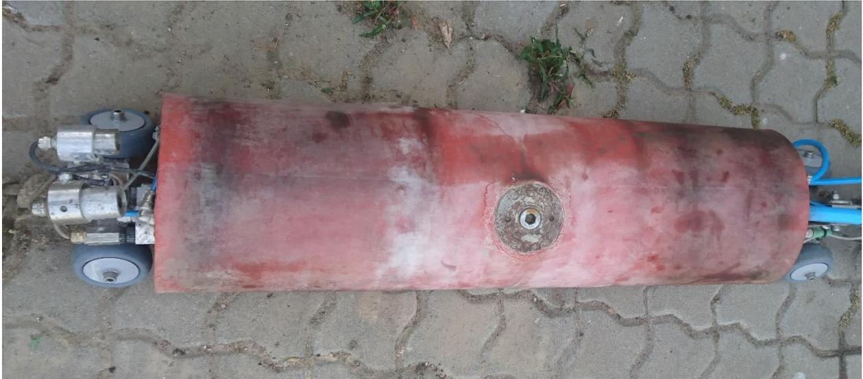
**Abbildung 1-10: Injektionspacker**
