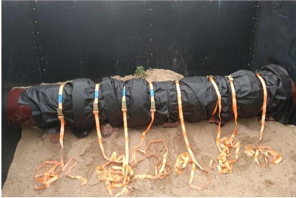
**Abbildung 6-11: mit Vlies umwickelt und verspannte Rohrschäden (1-4)**
