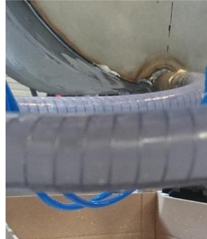
**Abbildung 5-7: Verbindungsschlauch zwischen Bevorratung und Pumpe**
