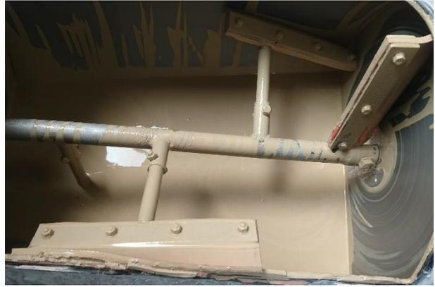
**Abbildung 5-14: B-Komponente mit Kaliumpermanganat nach einer 15-minütigen Bevorratung**
