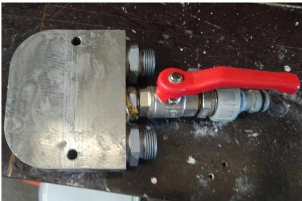
**Abbildung 5-10: Zulaufseite des Mischkopf**
