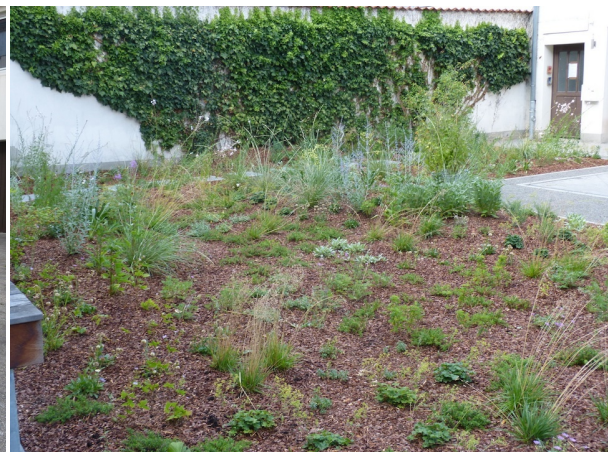
Foto 18: Der gestaltete Hof nach der Entsiegelung mit 50 qm versickerungsfähigen Belägen und 90 qm Vegetationsfläche bestehend aus etwa 500 Stauden und Gehölzen (Gerd Wach).
