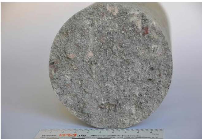
Abbildung 31: Vorderseite des Bohrkernes BR/K/11 (grünliche Varietät) mit durch Abwitterung aufgerauter Oberfläche
