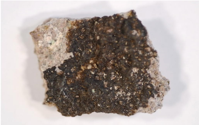
Abbildung 52: Oberflächenprobe BR/K/P1b von Rhyolithtuff mit starkem schwarzbraunem Überzug (Bildunterkante ca. 80 mm)
