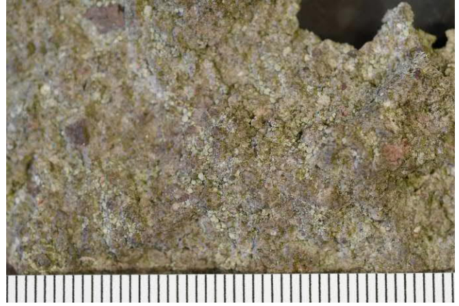
Abbildung 39: Gesteinsprobe BR/K/01a (Schale), Makroskopische Ansicht der Vorderseite mit erkennbar zerklüfteter, von Rissen durchzogener Oberfläche und starker biogener Besiedelung.
