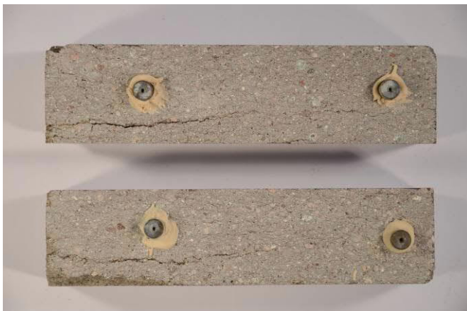
Abbildung 96: Prismen aus Rhyolithuff zur Bestimmung der thermisch-hygrischen Längenänderungen
