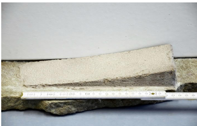
Abbildung 132: Keilförmig auf Rhyolithtuff aufgetragener Ergänzungsmörtel (Auftragshöhe 0...35 mm) nach Überarbeitung
