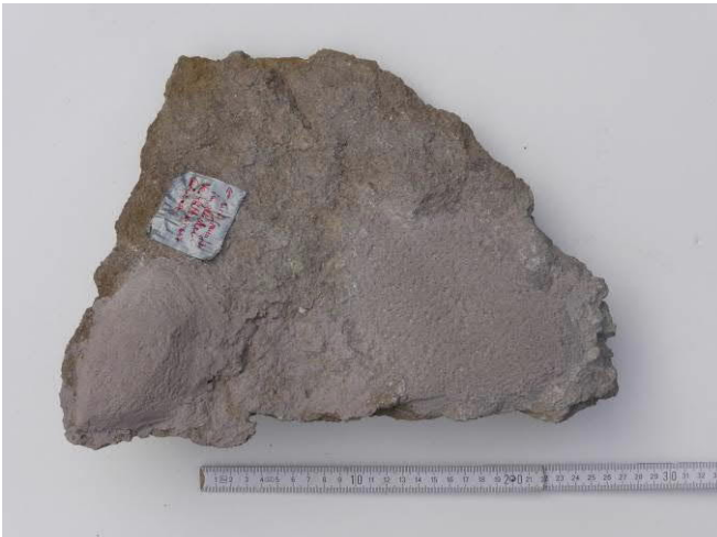
Abbildung 138: Musterauftrag des eingefärbten Restauriermörtels, Pigmentierung
