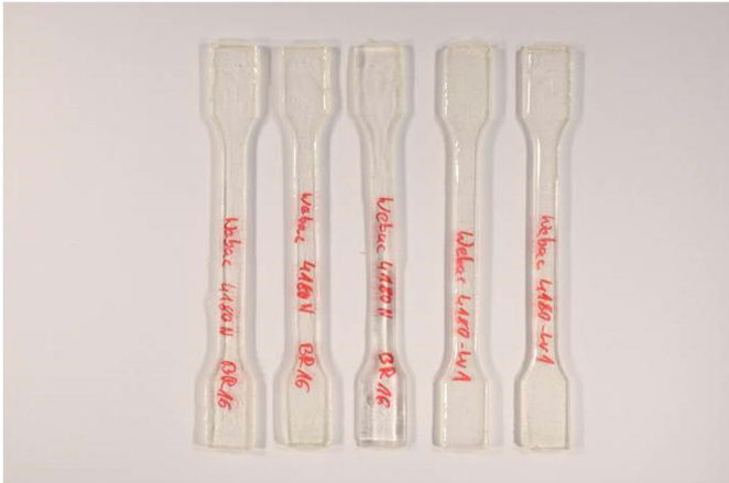
Abbildung 110: Prüfkörper für Zugversuche aus Epoxidharz webac 4180 N
