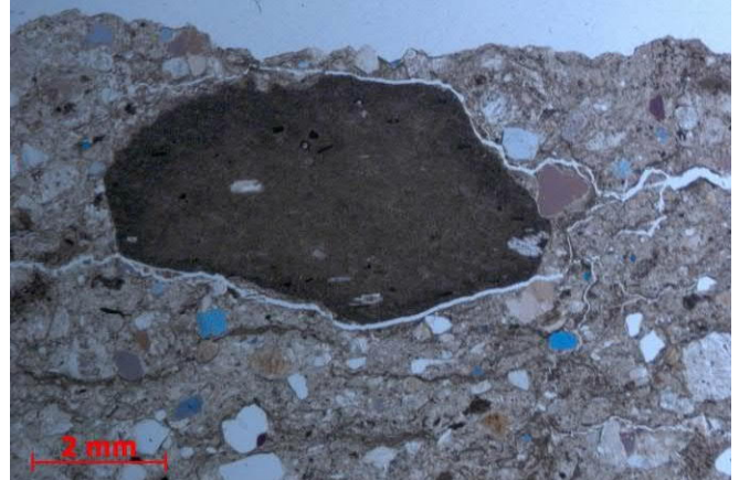
Abbildung 48: Gesteinsprobe BR/K/06a, Mikroskopaufnahme, Dünnschliff des Querschnittes der Schale mit starker Zerklüftung und Rissbreiten bis 0,3 mm. Der in der oberen Bildmitte erkennbare Pyroklast-Einschluss weist eine umlaufende Rissflanke auf. Die Schalenoberseite ist im Bild oben. Polarisatoren II
