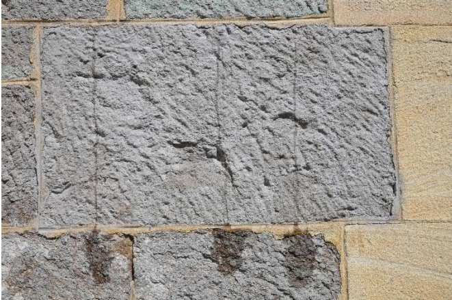
Abbildung 173: Benetzungsprobe des geschlammten und retuschierten Steinquaders aus Abbildung 172. Das Wasser läuft auf den wasserhemmend ausgerüsteten Schlämmen ab. Auf der Oberfläche des unbehandelten Steinquaders darunter dringt es dagegen sofort ein.
