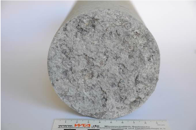
Abbildung 28: Vorderseite des Bohrkernes BR/K/13 (rötlich-violette Varietät) mit durch Abwitterung aufgerauter und leicht abschuppender Oberfläche
