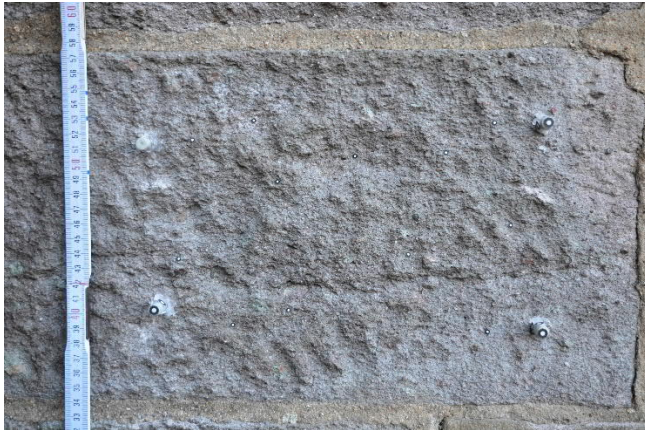
Abbildung 186: Messfläche 2 vor der Reinigung (violettgraue Variation, relativ gut erhaltene Oberfläche mit Bearbeitungsspuren)
