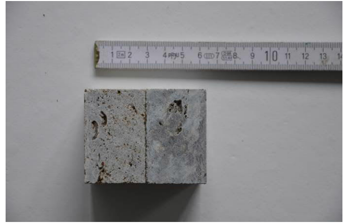
Abbildung 111: Prüfkörper zur Bestimmung der Haftzugfestigkeit an Naturstein (Quader 50x50x30 cm aus Oberdorlaer Muschelkalk)
