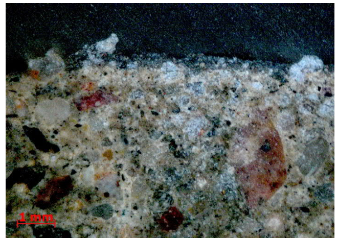
Abbildung 101: Anschliffprobe einer Verfugmörtelprobe (Mikroskopaufnahme) mit dichter Matrix des Mörtels. Die Oberflächenzone (oben) ist erkennbar zweilagig: Oberflächlich ist eine dunkle, ca. 0,2...0,3 mm starke, vermutlich gipshaltige Schicht erkennbar, darunter eine etwas stärkere gelblich verfärbte Zone.
