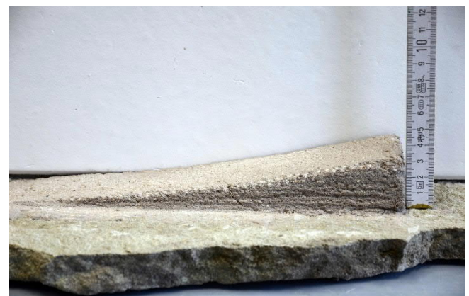
Abbildung 133: Ergänzungsmörtel nach dem seitlichen Rückarbeiten bis zur Längsachse: Der Mörtel ist über den gesamten Längsschnitt hinweg verfestigt.
