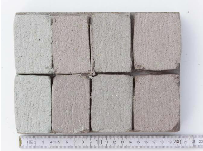
Abbildung 136: Farbmatrix für die Einfärbung der Ergänzungsmörtel (endgültige Farbfestlegung)
