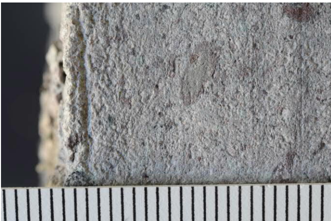
Abbildung 28: Vorderseite des Bohrkernes BR/K/13 (rötlich-violette Varietät) mit durch Abwitterung aufgerauter und leicht abschuppender Oberfläche
