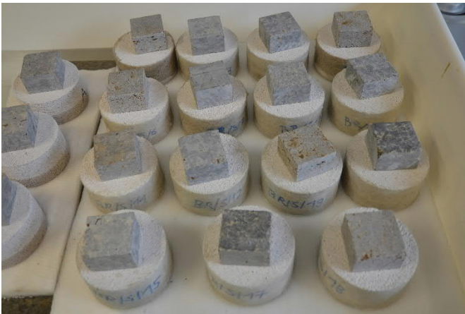
Abbildung 120: Ermittlung des kapillaren Wasseraufnahmekoeffizienten durch kapillares Saugen
