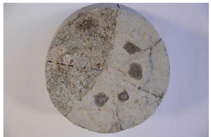
Abbildung 119: Gleiche Situation wie in Abbildung 118, Aufnahme 5 min nach Aufbringen der Wassertropfen auf die Kreissegmente. Auf den Schlämme mit 0,2 bzw. 0,3 M.-% Stearatanteil sind die Wassertropfen noch weitgehend vorhanden.
