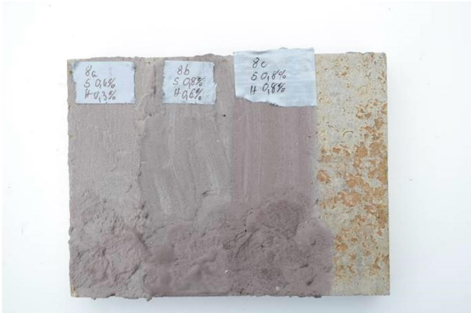
Abbildung 125: Favorisierte Farbabstufungen für die Schlämmen: Rotviolettöne die Pigmentzugaben sind in Masse-% angegeben (S...Oxidschwarz; H...Heiderot)
