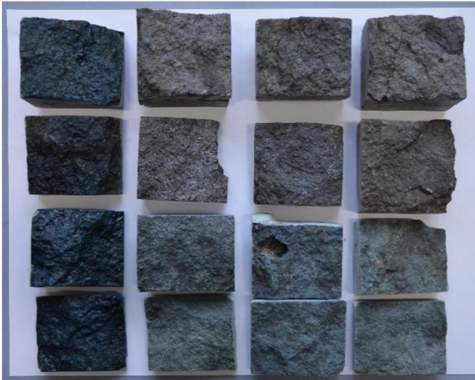
Abbildung 114: Rhyolithuff-Prüfkörper nach oberflächiger Tränkung mit mittels Keyplast Blue A eingefärbtem Epoxidharz, 10 Vol.-% Harz-Härter-Gemisch (obere 2 Reihen violett-graue, untere 2 Reihen grüne Rhyolithuffvarietät)
