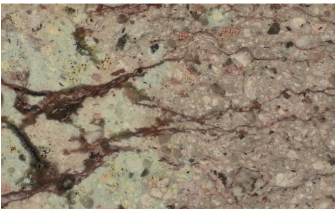
Abbildung 49: Gesteinsprobe BR/K/15-1 (rötlich-violette Steinvarietät), Querschnitt im Oberflächenbereich mit der ca. 5...10 mm starken Risszone. Darunter ist das Gefüge augenscheinlich ungeschädigt.
