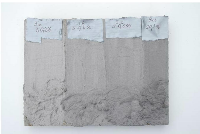
Abbildung 123: Favorisierte Farbabstufungen für die Schlämmen: Grautöne; die Pigmentzugaben sind in Masse-% angegeben (S...Oxidschwarz)
