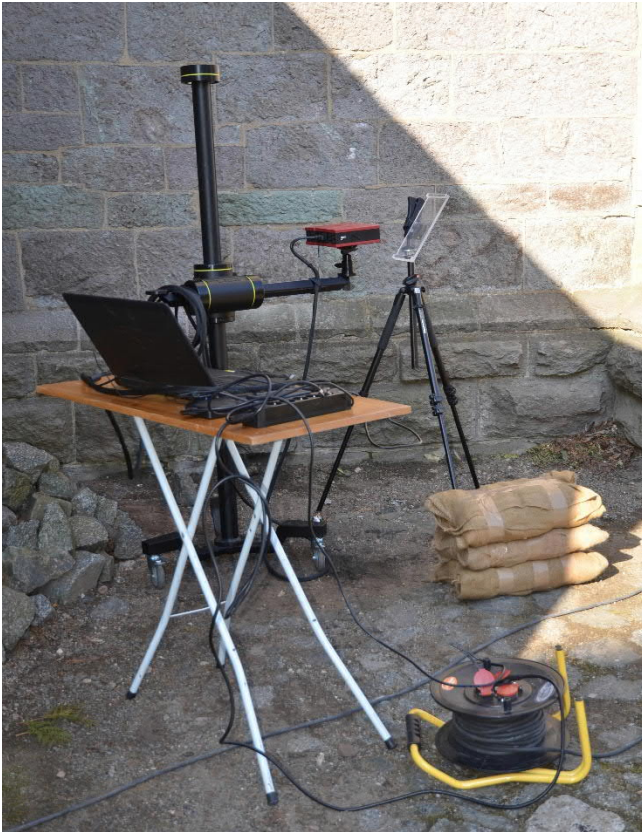
Abbildung 182: Messstand für das Streifenlichtscanning
