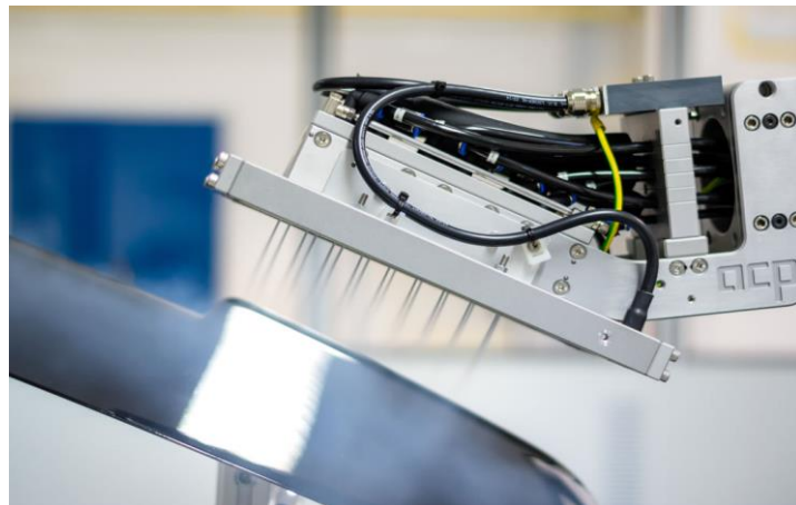
Bild 3-13: Mehrdüsen-Strahleinheit zur Reinigung großer Flächen, bspw. Stoßfänger vor dem Lackieren oder mehrere Bauteile in einem Tray gleichzeitig.
