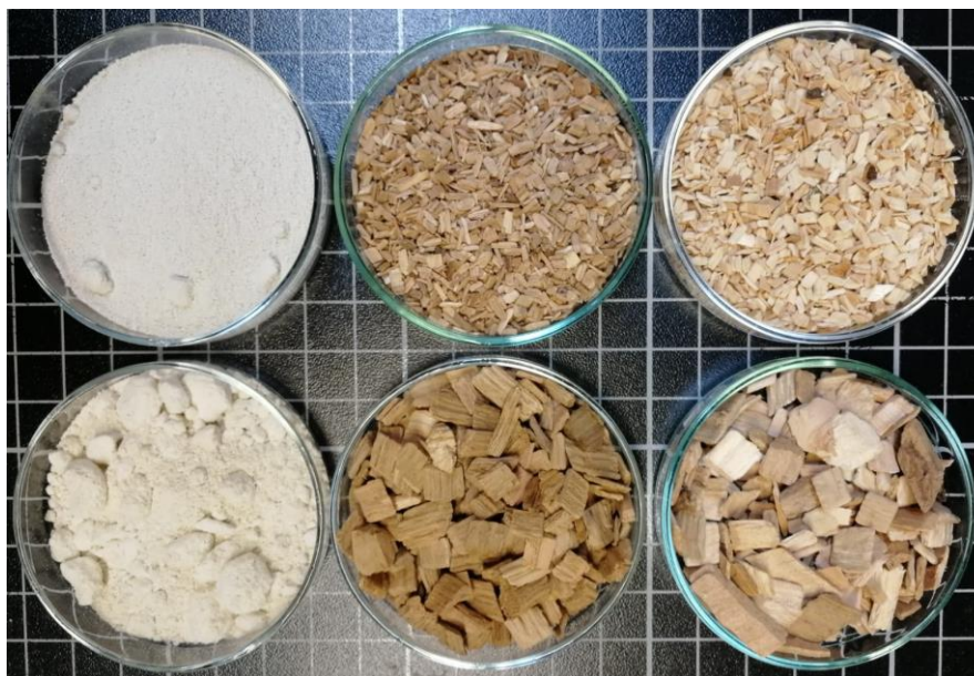
Abbildung 2.1: Kaolinsorten und Holzhackschnitzel für die Vorversuche zur technischen Umsetzung der Additiv- bzw. Kaolineinbringung (Kaolin A (oben links), feine Eichenholzhackschnitzel (EH1) (oben mittig), feine Buchenholzhackschnitzel (BH1) (oben rechts), Kaolin R (unten links), grobe Eichenholzhackschnitzel (EH2) (unten mittig), grobe Buchenholzhackschnitzel (BH2) (unten rechts)).
