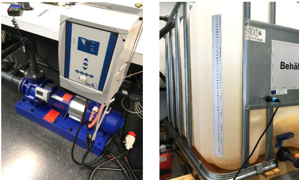
Abbildung 5: Fotografien mit Detailansichten des Versuchsstands. Links ist die Pumpe mit Frequenzumrichter dargestellt, rechts der Wasserbehälter mit induktivem Sensor.
