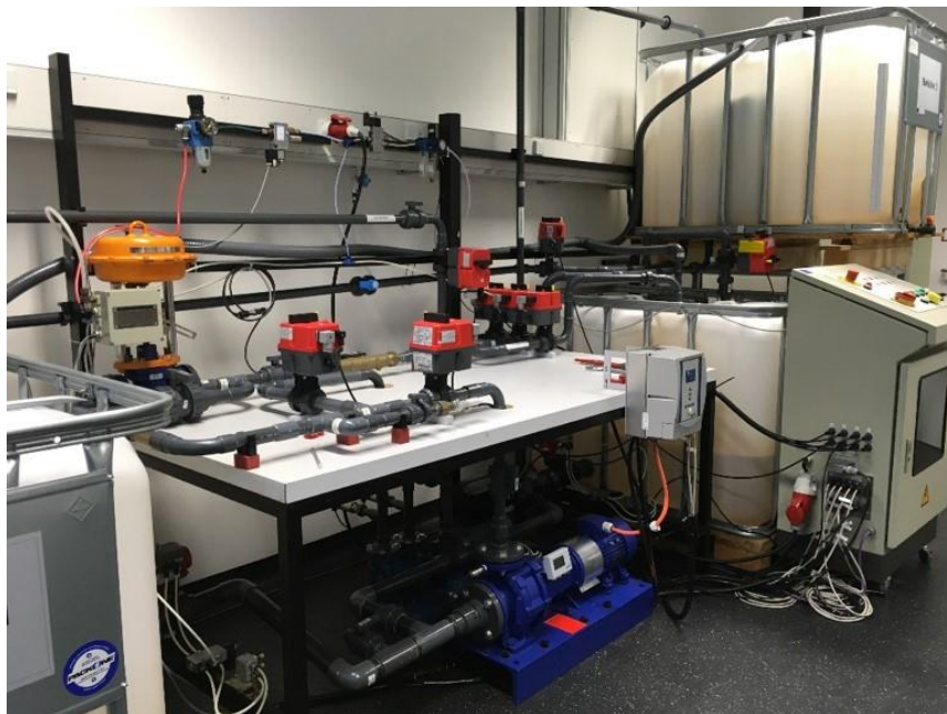
Abbildung 4: Fotografie des Versuchsstands mit Wasserbehälter auf der rechten Seite und der Kreiselpumpe unter dem Tisch.
