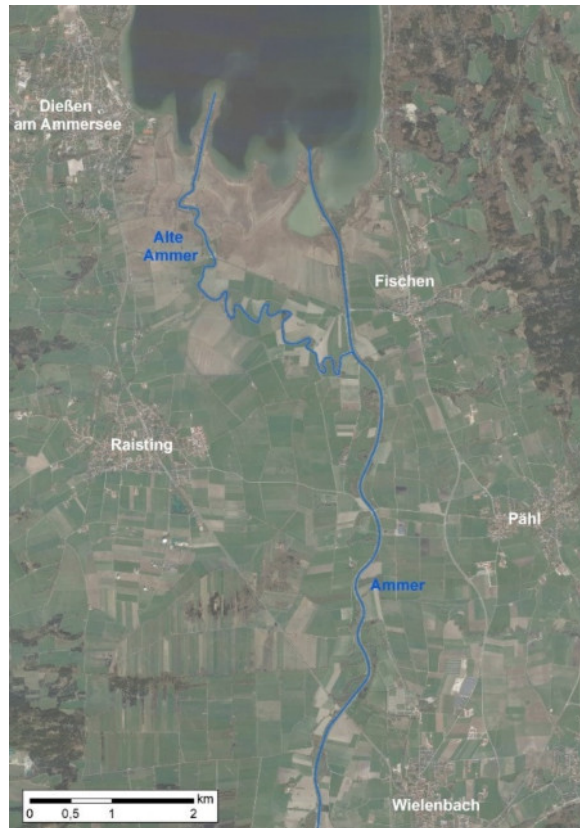
Abbildung 8: Untere Ammer bei der Mündung in den Ammersee. Der ehemalige Flusslauf wurde verlegt und später über Leitdämme zum Sedimentationsschutz weiter in den See geleitet. Der abgetrennte Flusslauf wird als Alte Ammer bezeichnet.
