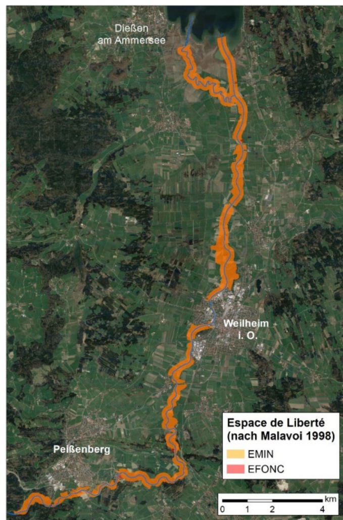
Abbildung 57: Der funktionelle Entwicklungskorridor (EFONC, rot) und der minimale Entwicklungskorridor mit restriktiveren Einschränkungen (EMIN, orange) an der Ammer im Projektgebiet nach dem Espace de Liberté-Konzept nach Malavoi et al. (1998).
