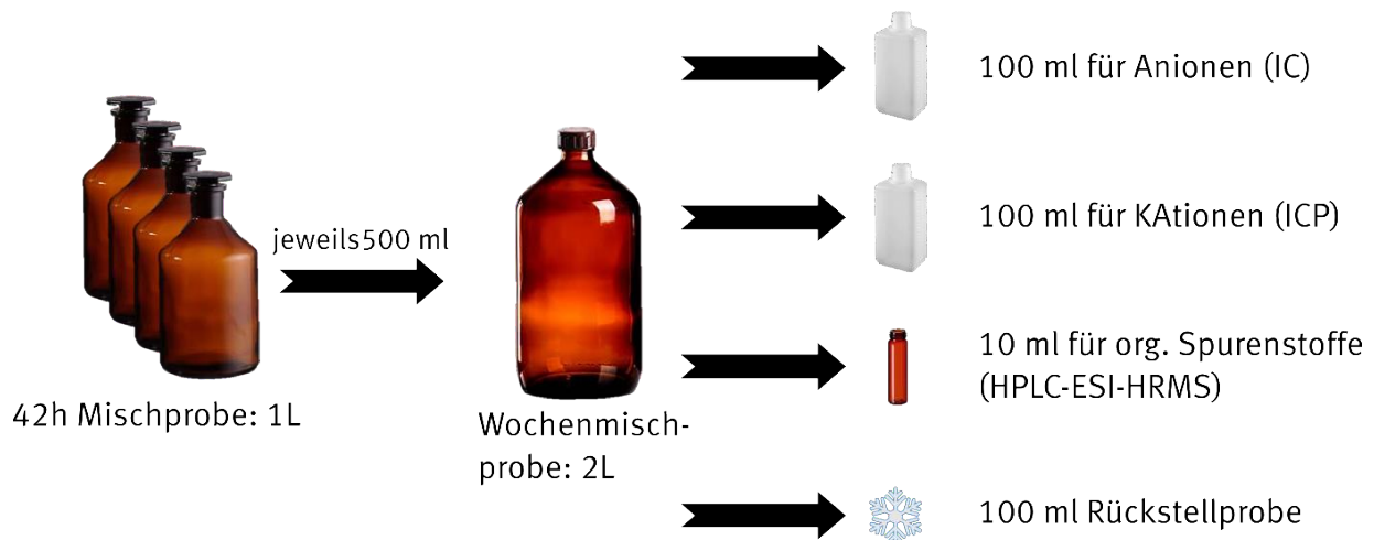
Abbildung 2: Herstellung der Wochenmischproben und Schritte der Analyse
