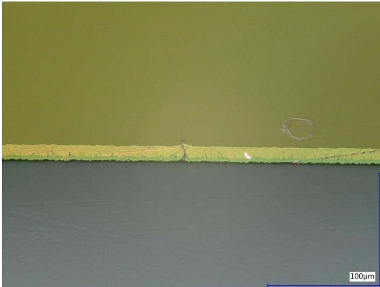
Abb. 46: Querschliff durch Fehlerstelle 1
