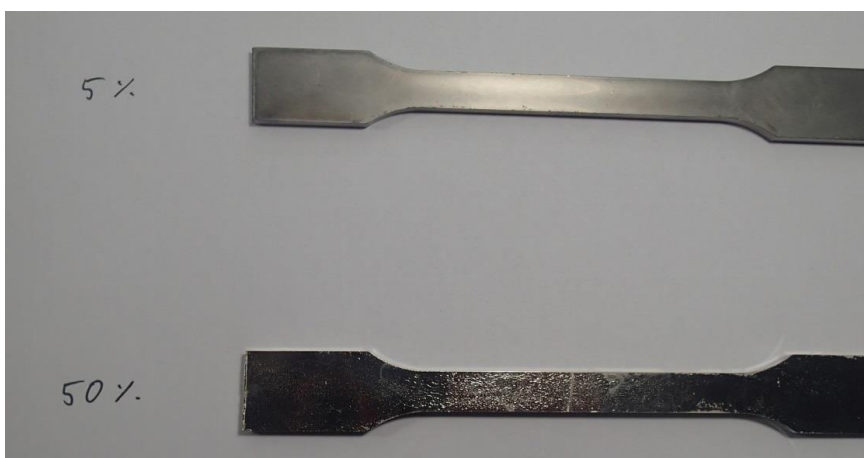
Abb. 17: Beschichtungsergebnis durch PA dotierte Beizlösung
