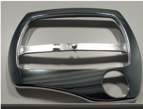
Abb. 48: Naviblende mit Kupfer-Nickel-Chrom Beschichtung
