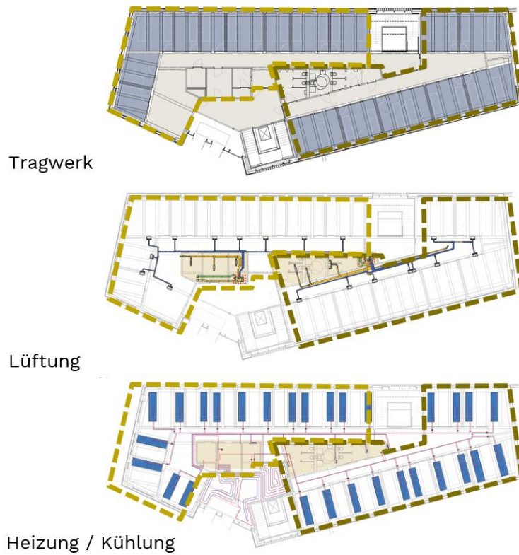
Abbildung 2-51 Integration von Nutzungsstruktur, Tragwerk und technischen Anlagen
