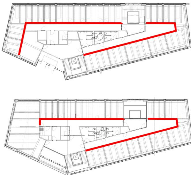
Abbildung 3-5 Schematische Darstellung des Bereichs der wiederverwendeten Systemwände
