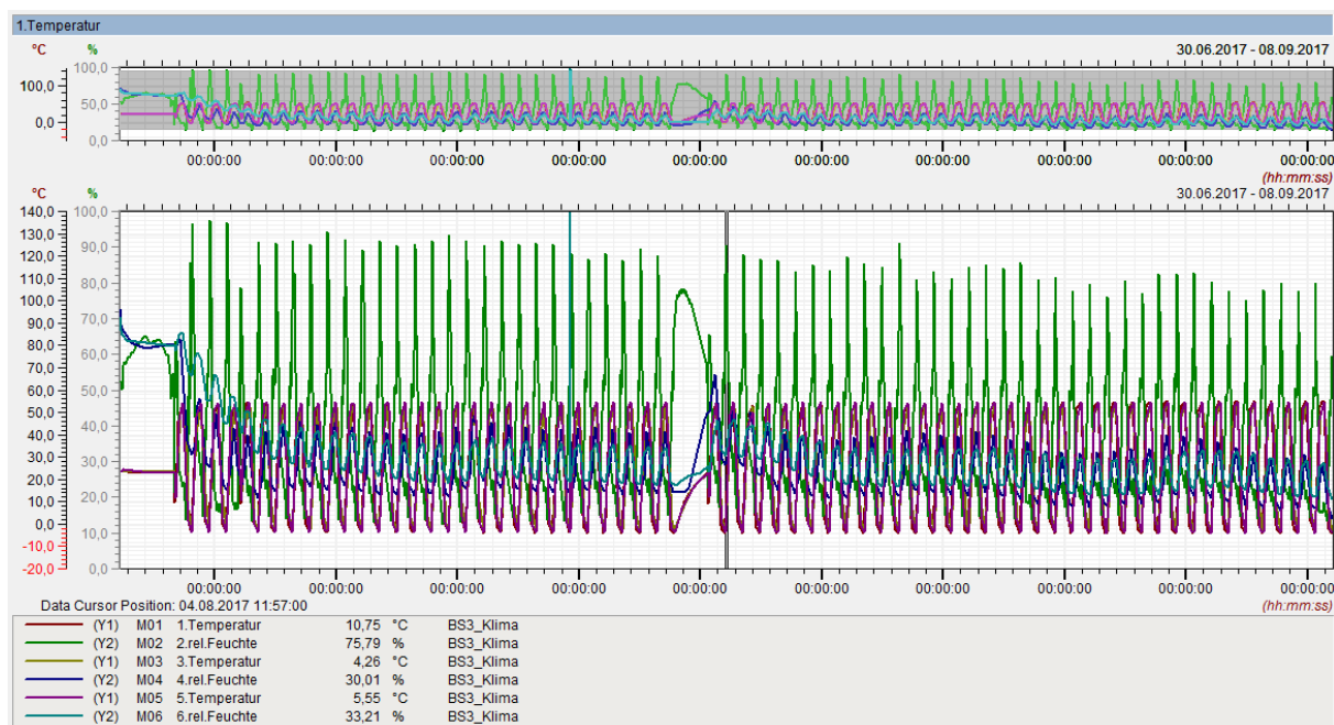
Abbildung 25: Klimadaten der Versuchsreihen BS3; Relative Feuchte in der Klimakammer und in Referenzproben.
