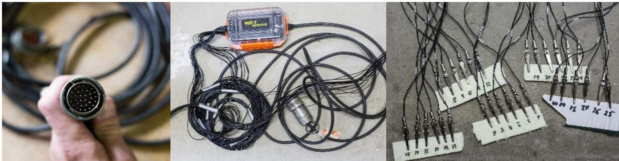
Abbildung 10: 32 poliger Anschluss des Mehrkernkabels der ABEM (links) kann zu 32 wasserdichten isolierten Einzelkabeln umgebaut (Mitte) und mit einzelnen Krokodilklammern an die Elektroden, die einzeln angesteuert werden können, angeschlossen werden (rechts).
