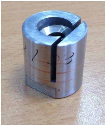
Bild 2: Beispielhafter Versuchsträger zur Prüfung der Schichtverteilung (umgebauter Formeinsatz)
