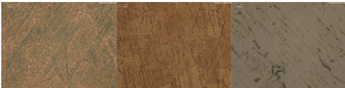
Bild 19: Aufsicht amorphe Zirkoniumdioxid Beschichtung (mitte), Aufsicht kristalline Zirkoniumdioxid Beschichtung (links), unbeschichteter Probekörper (rechts)
