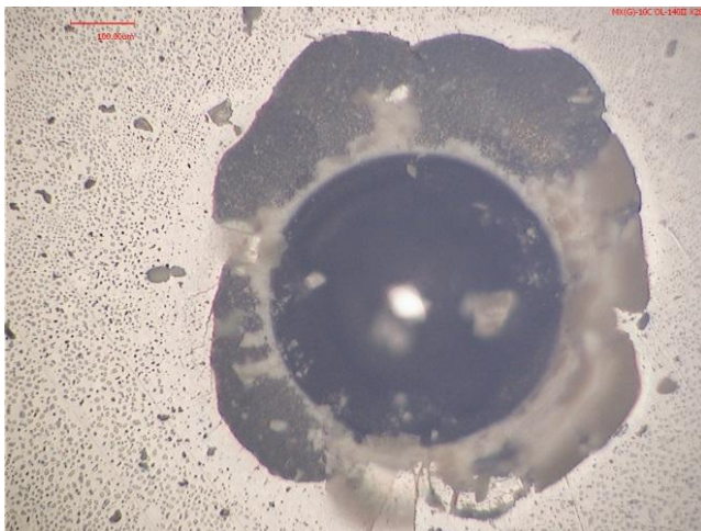
Bild 17: Härteeindruck in 1.2343, 52HRC mit Zirkoniumdioxid, 20µm
