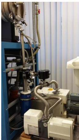
Bild 11: Kühlfalle im Vakuumtrakt (KIMW)
