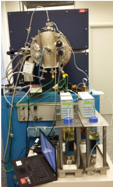
Bild 8: \mu Liqui-Flow Massflowcontroller für die Dosierung von lösemittelhaltigem Precursor (KIMW)
